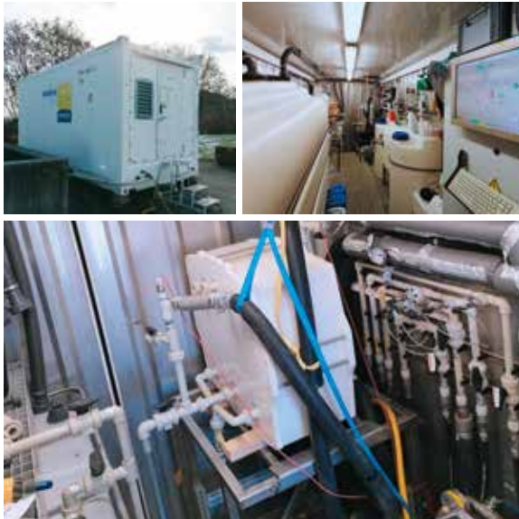
Eine in einem Container installierte Membrandestillationsanlage wurde für einen mehrmonatigen Realbetrieb an der Abwasserreinigungsanlage Gleisdorf installiert (Unten: Membrandestillationsmodul)
