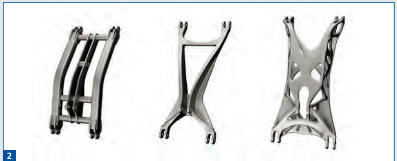
Abb. 2: Evolution eines Fahrwerksschwingen-Designs: Schweißkonstruktion (links), Gussausführung (Mitte), Designstudie zur weiteren Gewichthsoptimierung (rechts) Bildquelle: Amazone, voxeljet, ProGuss und Altair.
