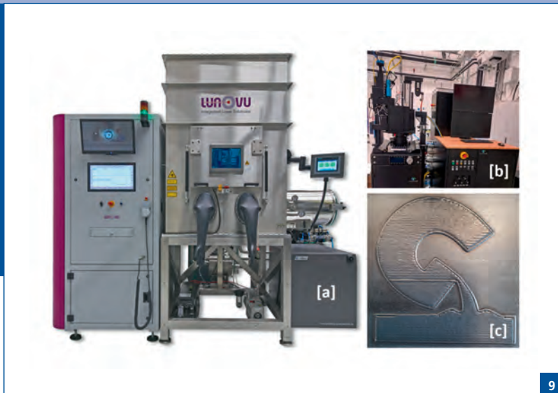
Abb. 9: a) LMD-System (Foto: www.das-design-plus.de , LUNOVU), b) Pulverbettanlage (LPBF- Laser powder bed fusion) und c) Logo des Gießerei-Institutes, additiv gefertigt.
