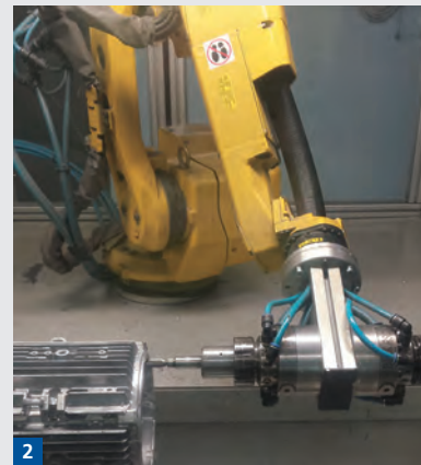
Abb. 2: An einem Roboter können problemlos mehrere Druckluftspindeln befestigt werden.
