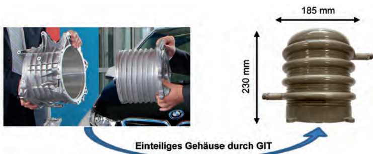
Abb. 2: Zweiteiliges Elektromotorgehäuse (li, (Hochschule Aalen 2014)), Einteiliges Elektromotorgehäuse mit integriertem Kühlkanal im Druckgießverfahren durch Gasinjektionstechnologie (GIT) hergestellt (re, Bildnachweis: Hochschule Aalen mit freundlicher Freigabe der Nemak Europe GmbH)
