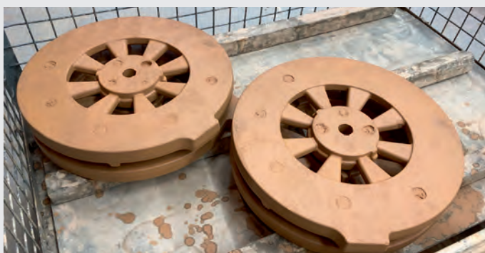
Abb.: Anorganisch gebundene Kerne 2 % Binder, Masse ca. 6 kg, geschlichtet
