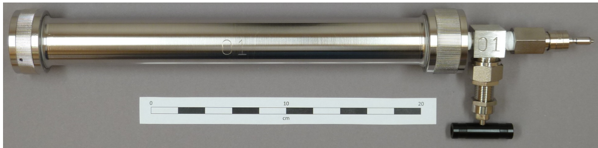
Abbildung 3.6: Rohrautoklav aus ‚Alloy 625‘
