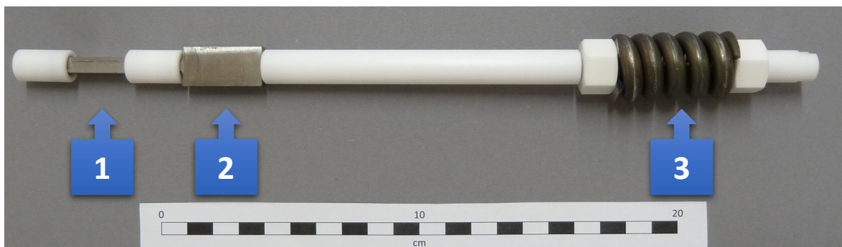
Abbildung 3.7: Probeneinbau für die Versuche bei erhöhtem Druck: Wasserstoffprobe (1), Coupon (2), Probensammenbau für CLTs (3) und PTFE-Teile (dazwischen, weiß)
