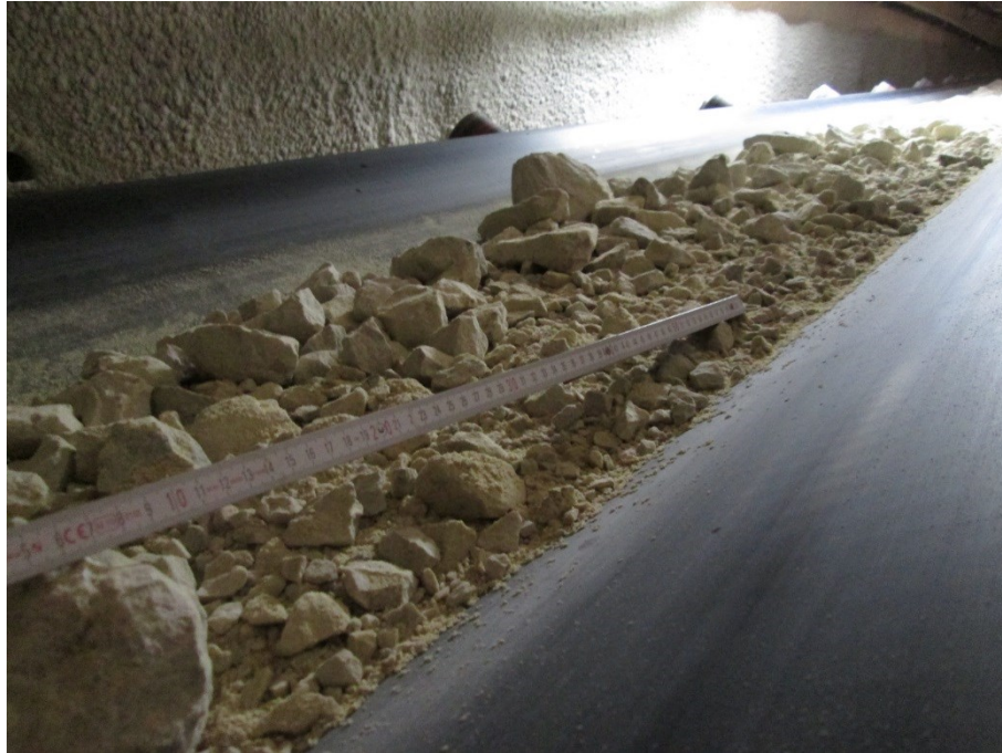
Abbildung 12: Mit Kalkstein beladenes Förderband im Elfitunnel ( k < 120\text{mm} , \dot{V} = 500\text{-}700\text{t/h} )
