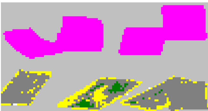
Abb. 3: PP-(rosa) und HDPE-Partikel deren Pixel mit Falschfarben versehen wurden (Rosa=PP, Grau=HDPE, Grün=PET, Gelb=Nicht klassifiziert)
