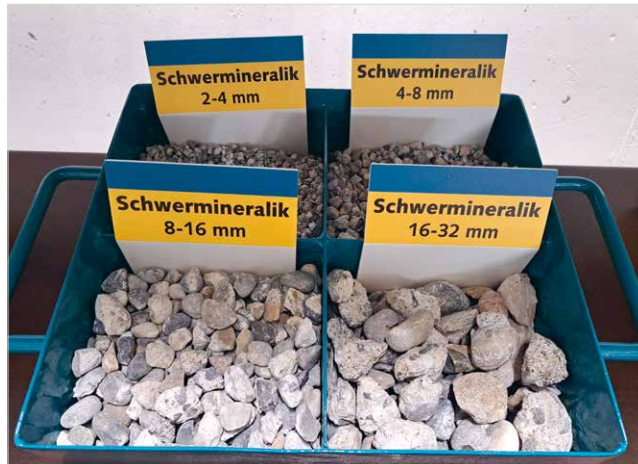
| Rezyklierte Gesteinskörnungen aus Abbruchabfällen
