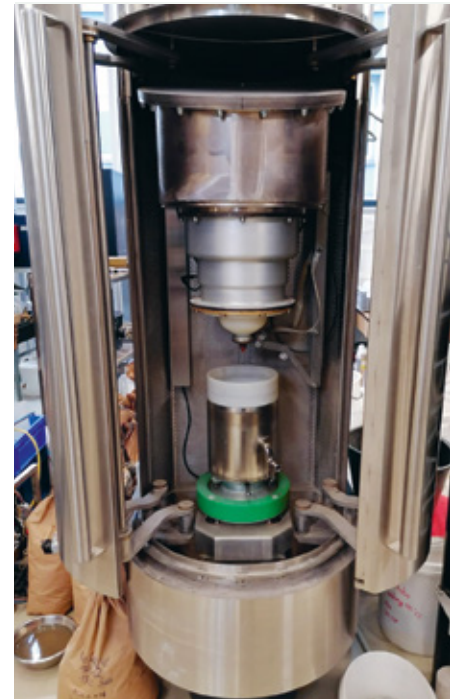
Elektrodynamische Fragmentierung „SELFRAG Lab“ am Lehrstuhl für Aufbereitung und Veredlung © MONTANUNIVERSITÄT LEOBEN
