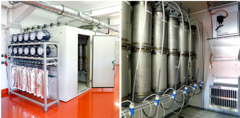
Abbildung 1: Ansicht der gesamten Versuchskonstellation mit Thermokammer und Messvorrichtung (links) sowie Gärreaktoren, Perkolatbehältern und Perkolatpumpen im Inneren einer zentral beheizten Thermokammer (rechts); Bilder: Florian Wehking
