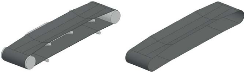
Abbildung 5: Vereinfachtes CAD-Modell eines beispielhaften Gurtförderers (li.) mit Flächenmodell des Gurtes (r.)
