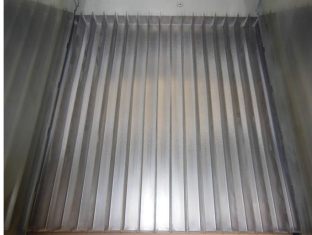
Abb. 8: Blick auf die 17 Becher im Trennraum des Hamos Freifallscheiders
