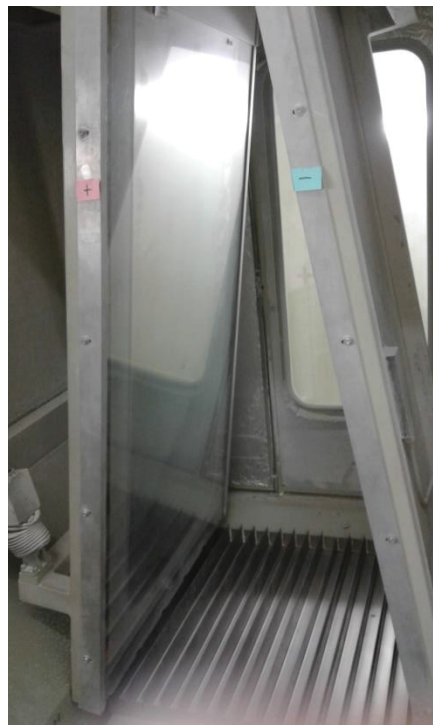
Abb. 46: Blick in die Trennzone des Hamos-Freifallscheiders EMS500 mit eingestellten Bechern
