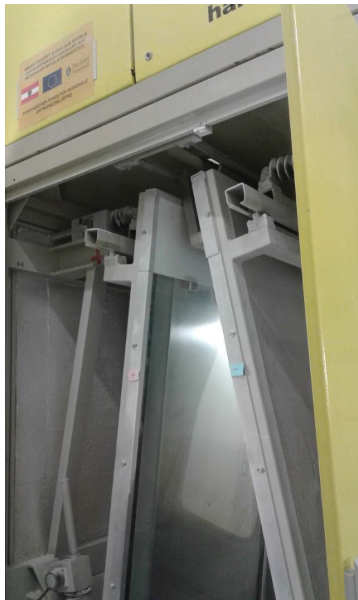
Abb. 7: Blick in den Prozessraum des Hamos Freifallscheiders EMS500 bei geöffneten Türen
