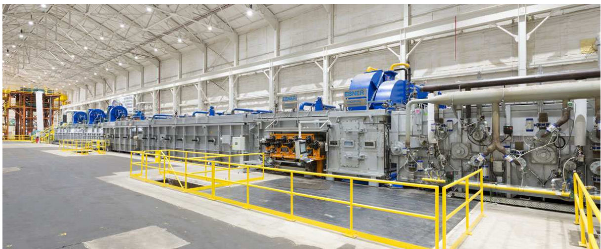
Abbildung 2.10: HyCAL -Anlage mit Jet-Kühler, Gleichrichtereinheit und Auslagerungszone [49].
