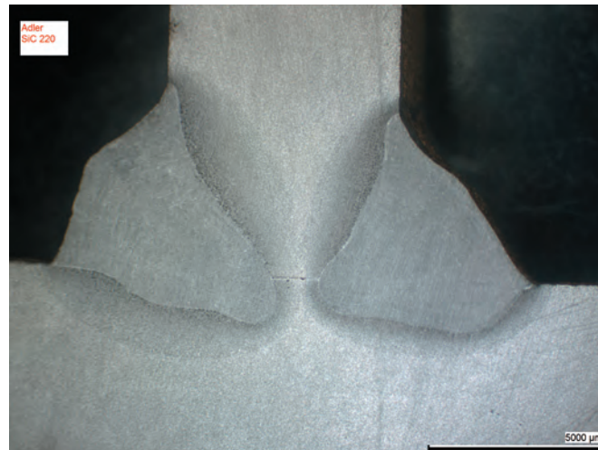
Abb. 2: Bsp. eines Makroschliffs an einer Schweißnaht nach erfolgter Ätzung zur Sichtbarmachung der Schweiß- und Wärmeeinflusszonen.
