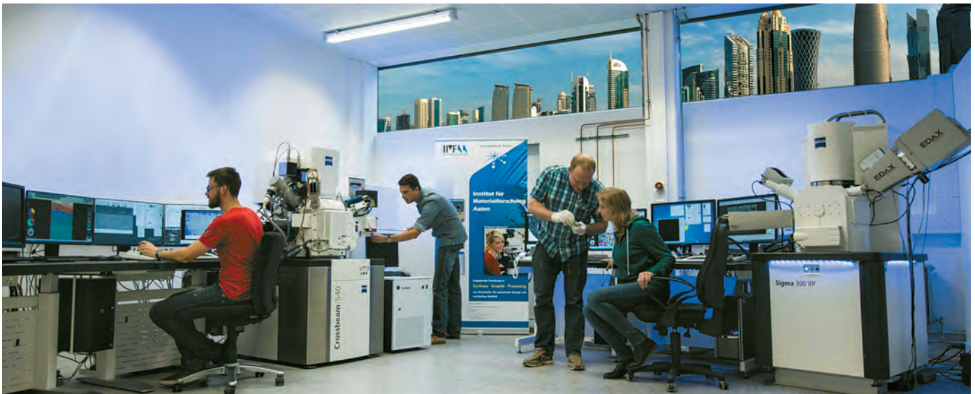
Rasterelektronenmikroskopielabor des Instituts für Materialforschung mit umfangreicher Mikroanalytik und Nanobearbeitung mittels Laser- und fokussierter Ionenstrahlpräparation (FIB).
