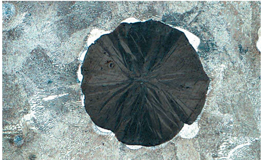
Gusseisen mit Kugelgraphit mit perlitischer Matrix, Nital-Ätzung, Hellfeld, 500x
