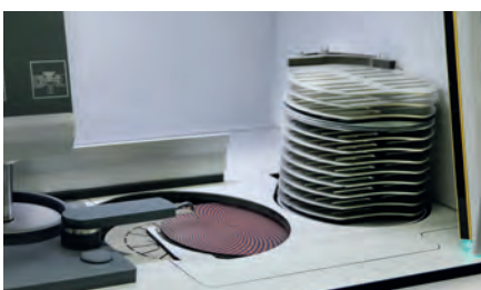
Abb. 2: Die Schleif- und Poliermedien werden aus dem 16-fachen Magazin automatisch gewechselt.
