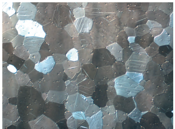
Abb. 7: Titanoberfläche nach ausreichender Präparation mit sehr geringer Restverformung durch den Schleif- und Polierprozess, ausgeprägt als Verformungszwillinge.
