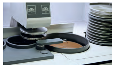
Abb. 5: Schleif- und Polierkopf fährt automatisch die Stationen an.
