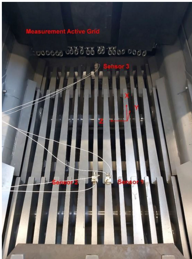
Abb. 4: Messaufbau Active Grid®
