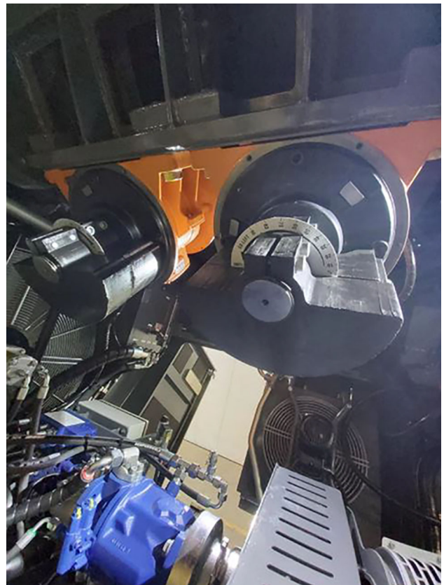
Abb. 5: Unwuchtmotoren mit der Einstellung 100% Unwucht
