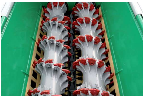
Bild 1: Blick in den Zerkleinerungsraum eines Zweiwellenzerkleinerers [1]
