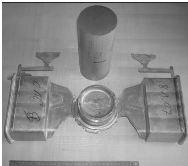
Abb. 4: Vorne: Bauteil mit Anschnittsystem, hinten: Bolzen
