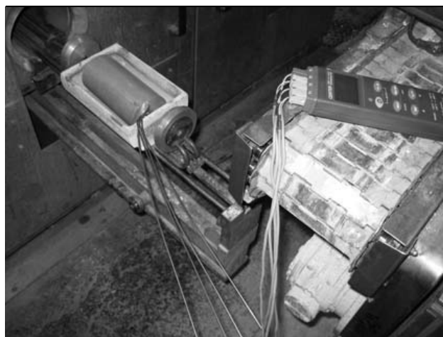
Abb. 6: Positionen der Thermoelemente im Bolzen
