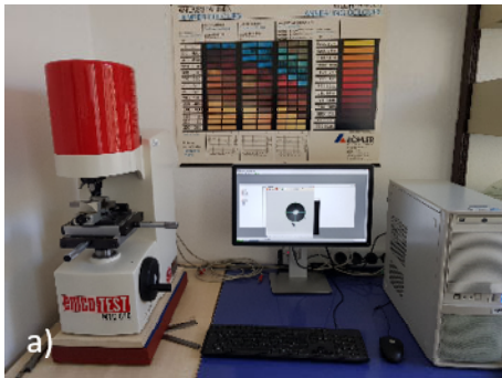
Abbildung 5.7: a) Härteprüfgerät EMCOTEST M1C 010 und b) Positionen der Härtemessungen am Längs- und Querschliff (siehe Abbildung 5.6)
