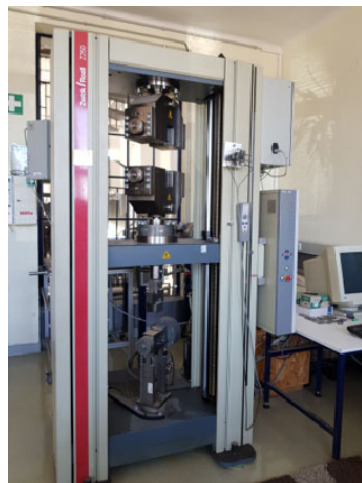
Abbildung 5.5: Zugprüfmaschine Zwick/Roell Z250 am LS f. Umformtechnik (Montanuniversität Leoben)
