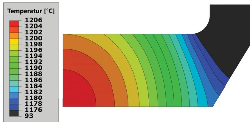
Abbildung 5.5: Temperaturfeld innerhalb der Torsionsprobe nach 300 s bei 1200 °C.
