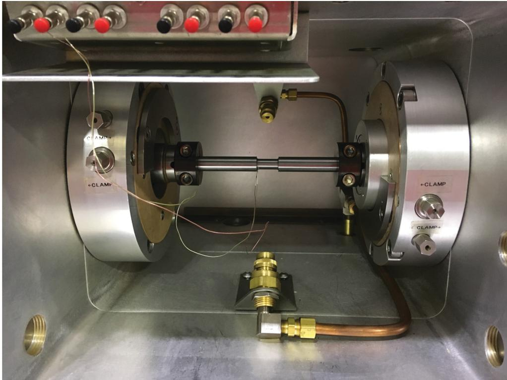
Abbildung 3.1: Versuchsaufbau Heißtorsion Gleeble 3800-GTC. Eingebaute Torsionsprobe SMT001 mit angeschweißtem Thermoelement.
