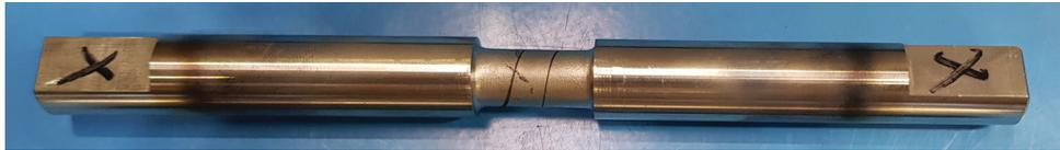
(b) Nach dem Torsionsversuch.
