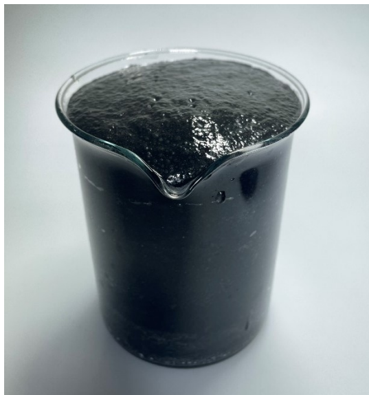
Abbildung 21: Flotation des Kohlenstoffes in einem Becherglas
