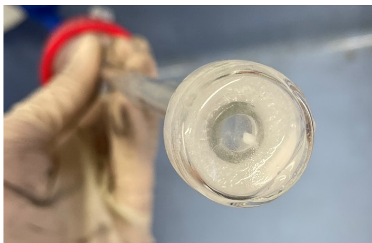
Abbildung 25: Niederschlag in der Fritte des Gaswäschers
