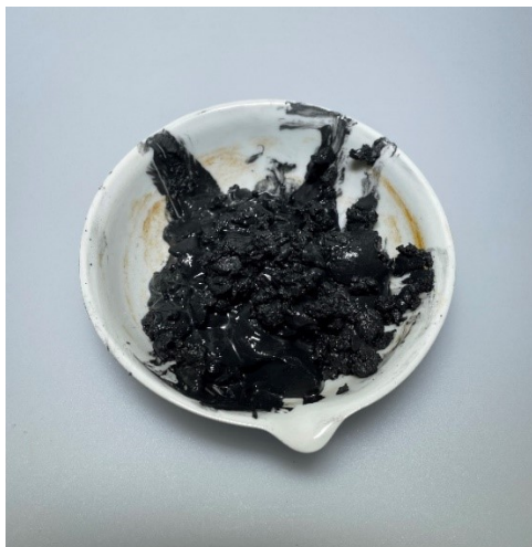
Abbildung 28: SPL Feststoff nach dem Zentrifugieren und Abziehen des Überstandes
