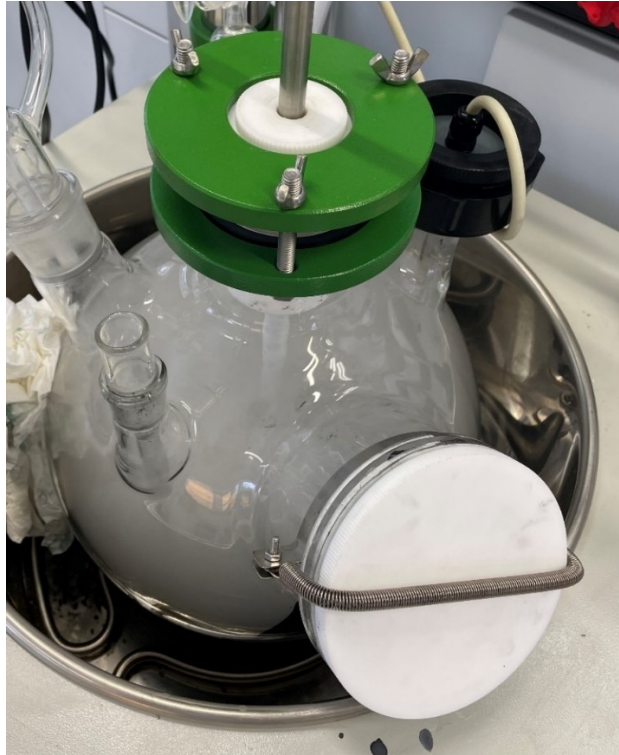
Abbildung 20: Glasreaktor gefüllt mit \text{SiF}_4
