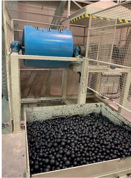
Abbildung 13: Kugelmühle zur Zerkleinerung des Ausbruchmaterials
