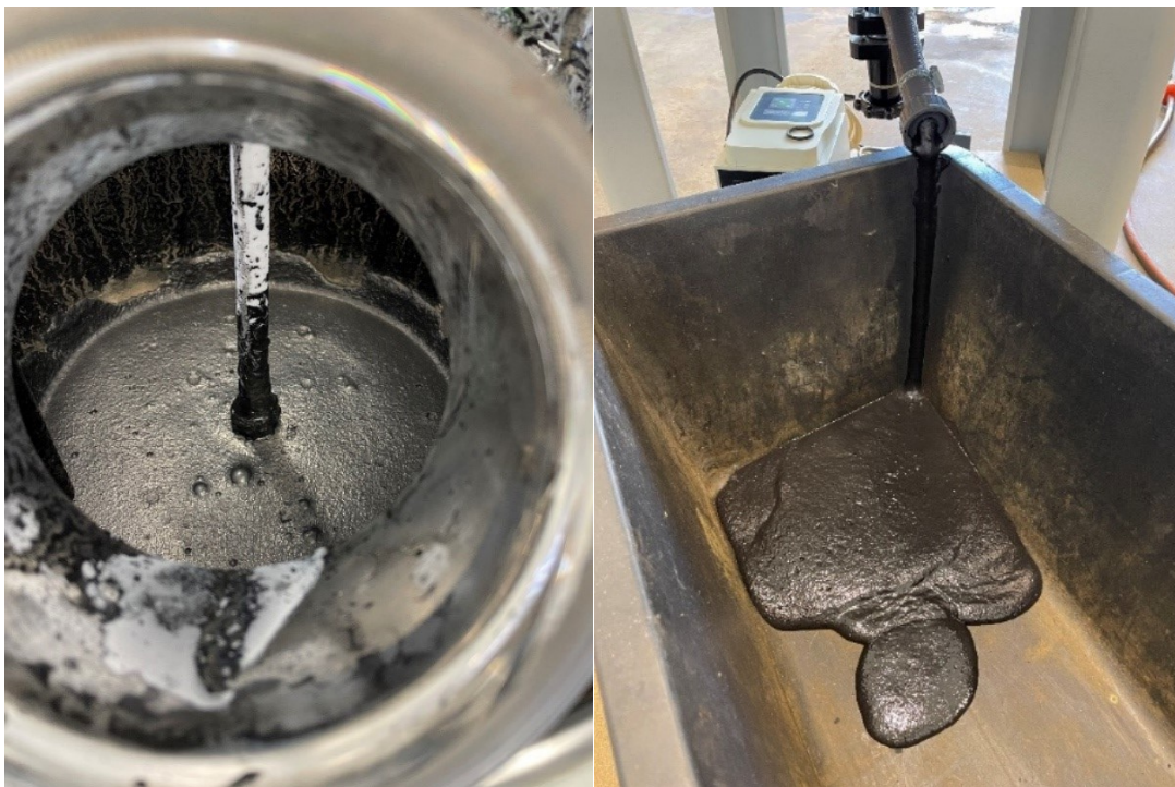
Abbildung 24: SPL-Suspension nach der Säurebehandlung
