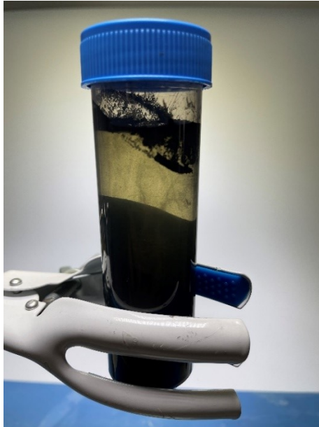
Abbildung 27: Feststoff und Flüssigphase nach dem Zentrifugieren
