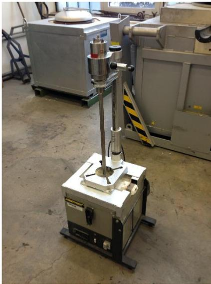
Aufbauend auf der Konstruktion eines geeigneten Versuchstandes zur Beschallung von Aluminiumschmelzen im Labormaßstab (Abbildung links) soll im Rahmen dieser Arbeit die Entgasungswirkung der Ultraschalltechnik anhand der Legierung Al 99,7E untersucht werden. Die Ergebnisse zeigen eine zufriedenstellende Abnahme des Dichteindex sowie eine positive Wirkung der Ultraschallbehandlung auf die Flächenporosität und die Ausdehnung der Gasporositäten (Abbildung unten).
