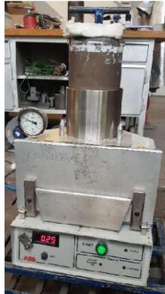
**Abbildung 3-6:** Verwendete PoDFA-Vorrichtung (Porous Disc Filtration Apparatus) während dem Prozess.
