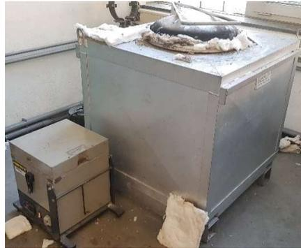
**Abbildung 3-2:** Verwendete Schmelzöfen für PoDFA Vorversuche.
