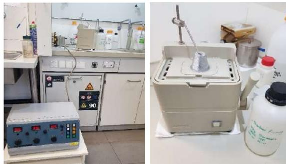
**Abbildung 3-7:** Verwendetes elektrolytischer Barker Ätzgerät am ÖGI.
