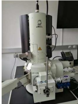
**Abbildung 3-11:** Verwendetes REM mit EBSD und EDX Einheit.
