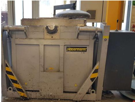
**Abbildung 3-1:** Verwendeter Schmelzofen von Nabertherm für die Herstellung von 40 kg Schmelze.
