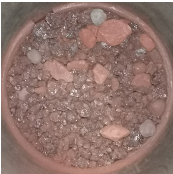
Abbildung 38: RUL 100kg C-DRI vor Versuch in D125-Retorte
