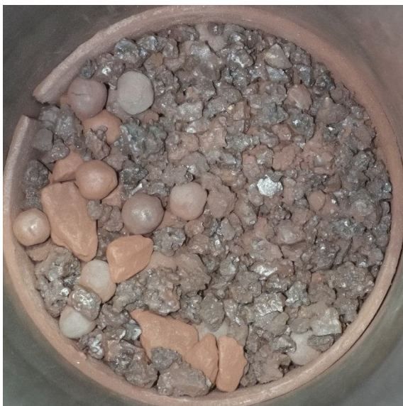
Abbildung 34: RUL 100kg H 2 -DRI vor Versuch in D125-Retorte
