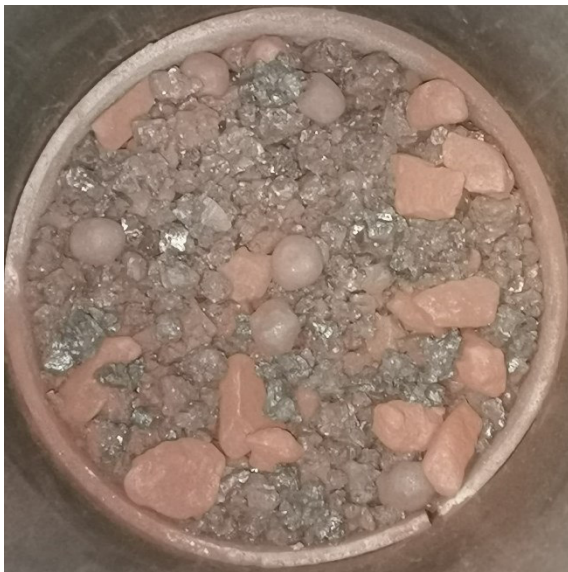
Abbildung 32: RUL 0kg H 2 -DRI vor Versuch in D125-Retorte
