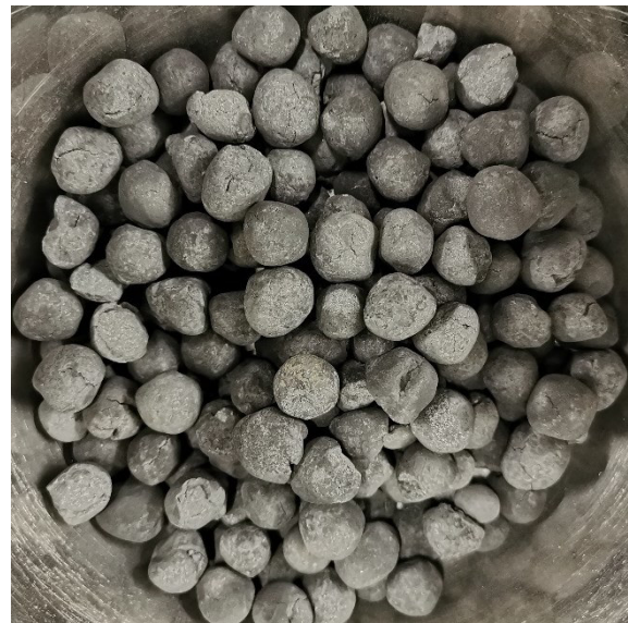
Abbildung 25: NT-Zerfall H 2 -DRI größer 6,3 mm
