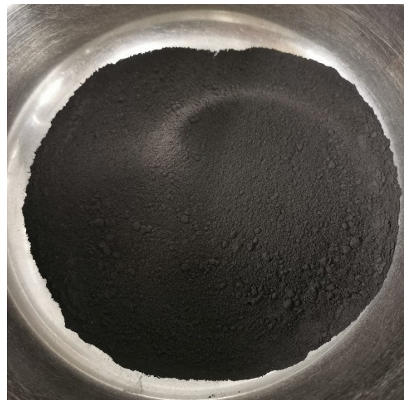
Abbildung 31: NT-Zerfall H 2 -DRI kleiner als 0,5 mm
