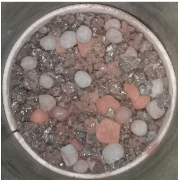
Abbildung 36: RUL 200kg H 2 -DRI vor Versuch in D125-Retorte
