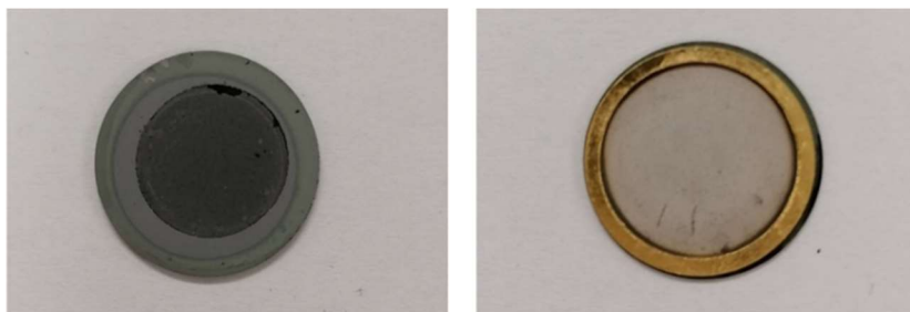
Abbildung 5-22: Zelle 54 nach Testabbruch. Die Lufolektrode ist vollständig delaminiert (links).
