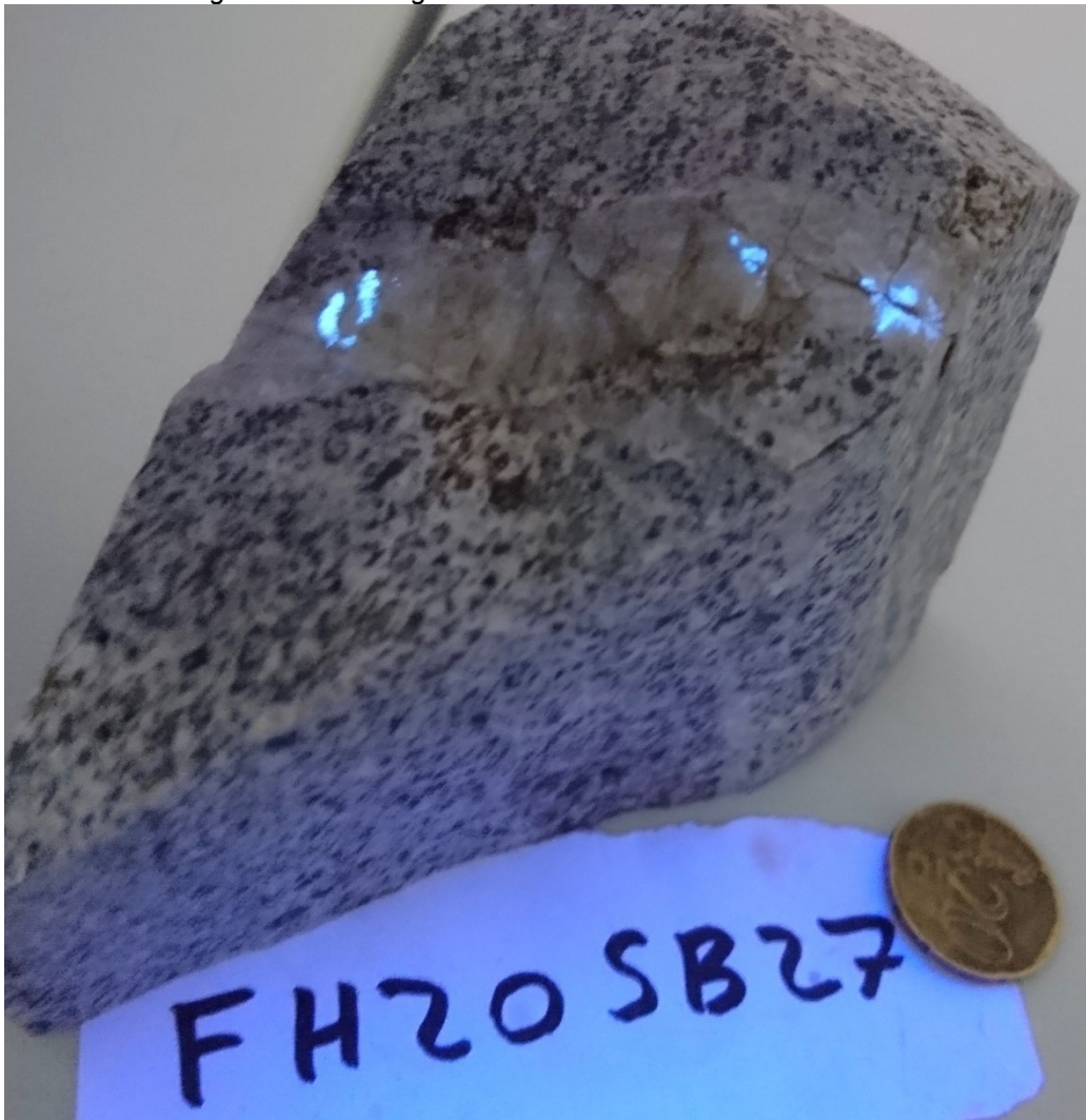
Abbildung 41: Quarzgang mit Scheelit in Granodiorit unter UV-Licht
