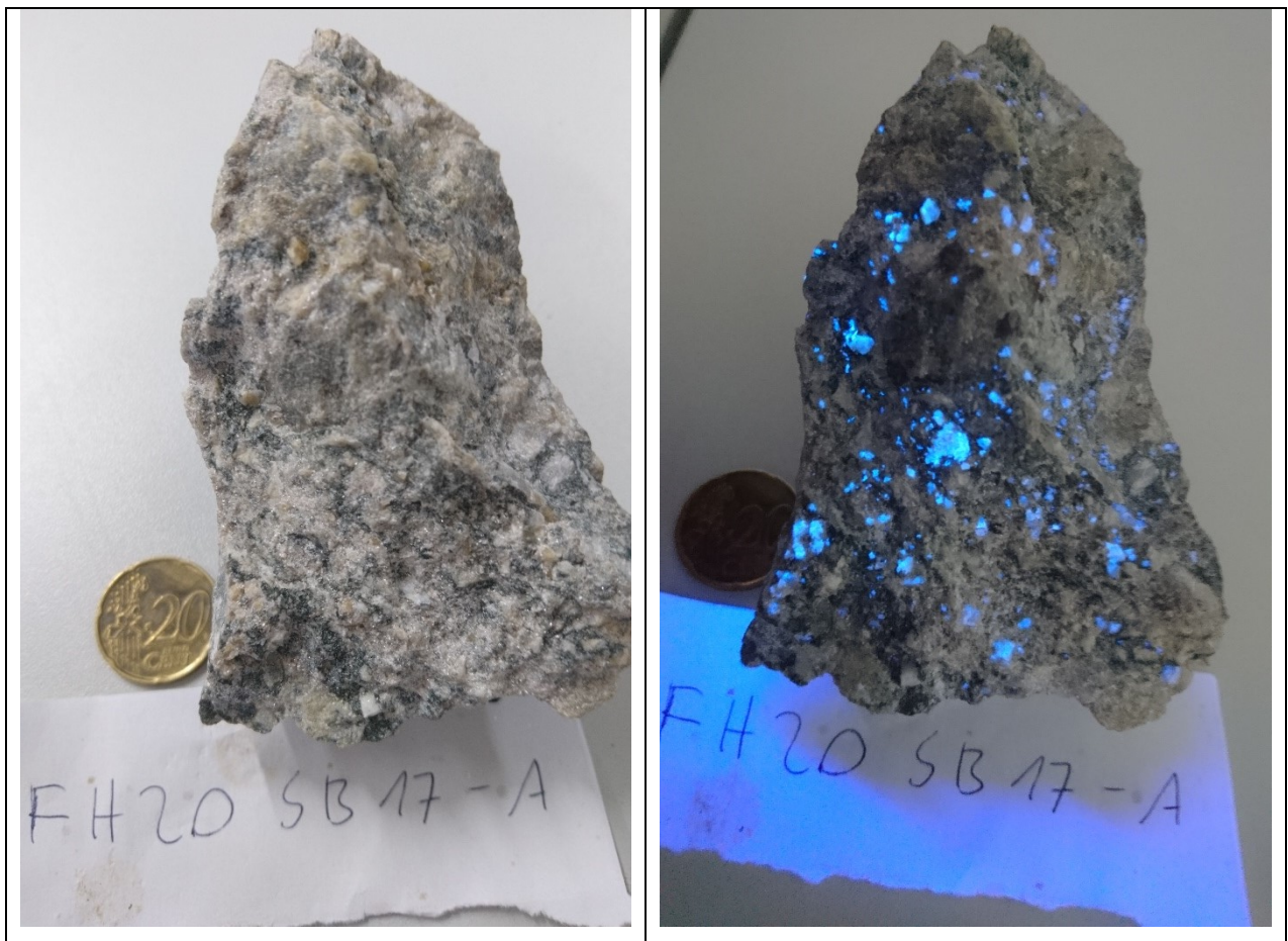
Abbildung 22: Scheelitreiches Kalksilikatgestein aus einem Gang im Unterbaustollen; Links: Ohne UV-Licht; Rechts: Unter UV-Licht
