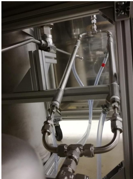
Abbildung 29: Kühler in Form eines Gegenstrom-Wärmetauschers
