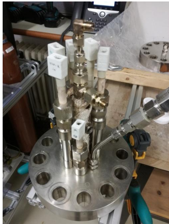
Abbildung 9: Der Deckel des Reaktors im Detail
