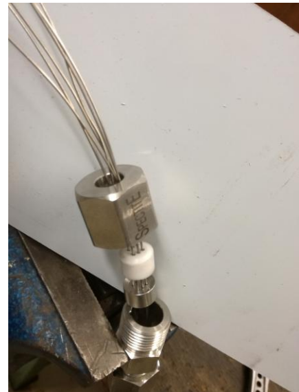
Abbildung 35: Die Seriedurchführung für die sechs Thermoelemente im Inneren des Reaktors
