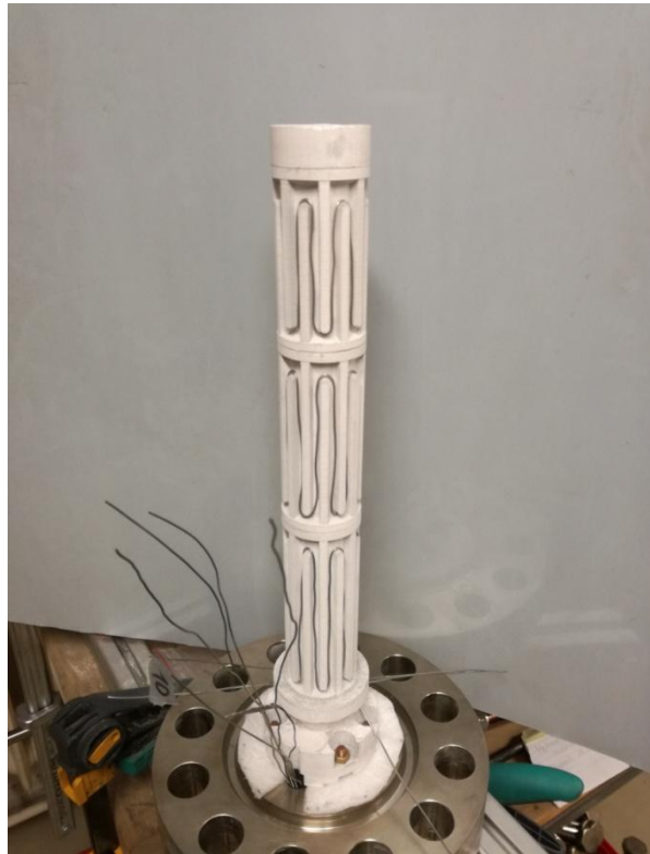
Abbildung 11: Komplettes Heizmodell stehend am oberen Reaktordeckel
