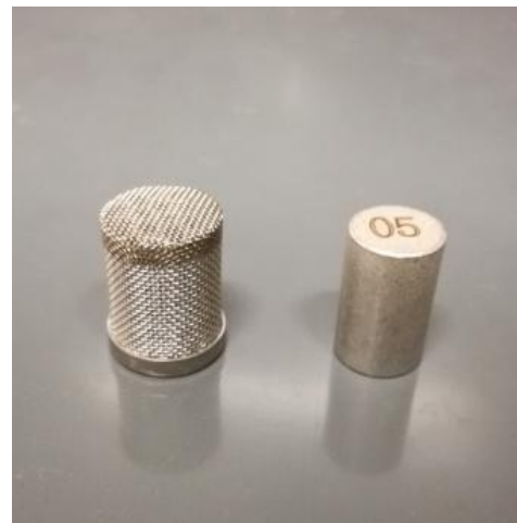
Abbildung 28: Die verwendeten Filterelemente für den 12 mm- bzw. 6 mm-Filter mit einer PorengröÙe von 440 (links) bzw. 0,5 µm (rechts) im Vergleich
