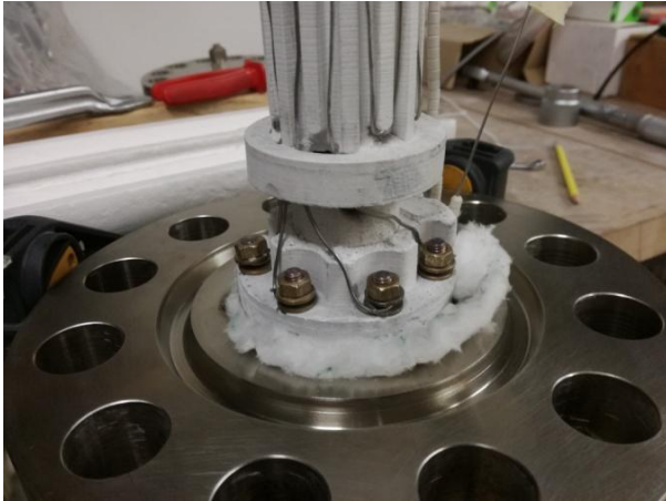
Abbildung 12: Die zwei oberen Begrenzungssteine, sowie die an den Kupferelektroden fixierten Heizdrähte
