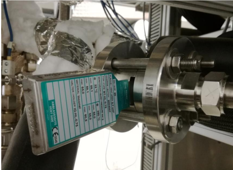
Abbildung 25: Die Berstscheibe liegt zwischen zwei Halterungen und wird mit Flanschen verpresst
