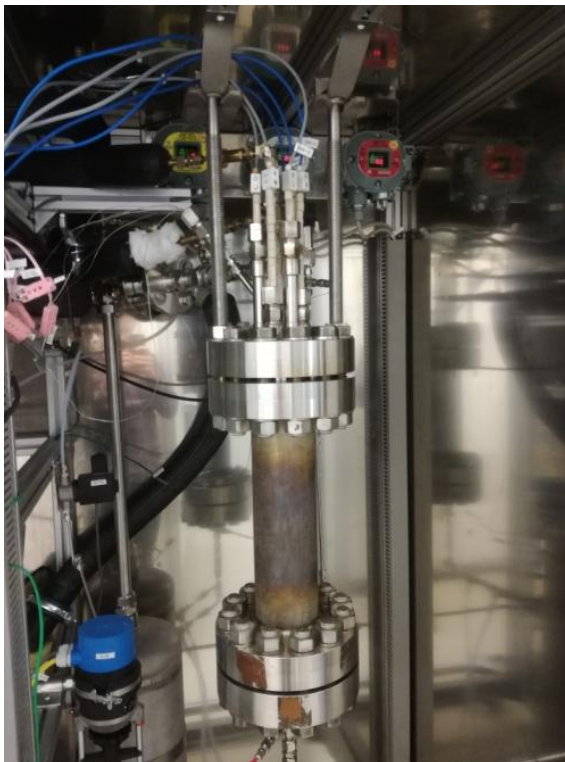
Abbildung 8: Der Reaktor in seiner Endposition ohne äußere Wärmedämmung
