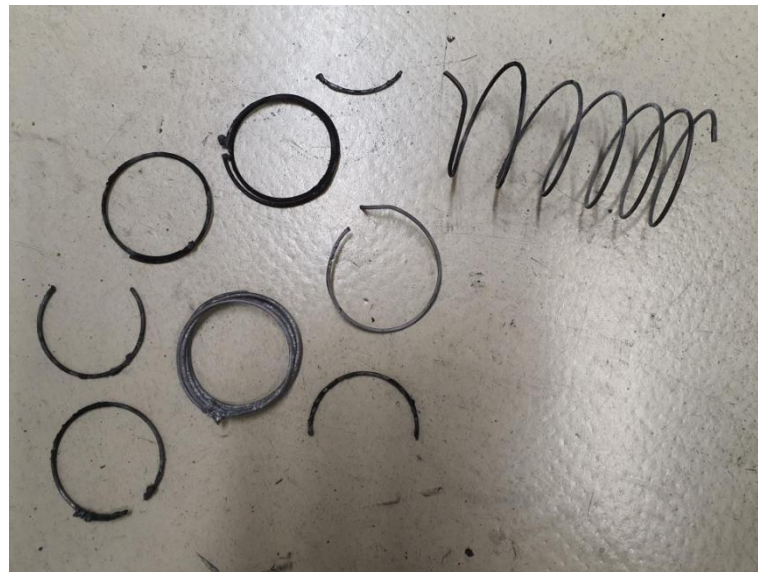
Abbildung 43: Mehrfach gebrochene Heizspirale bei Versuchen mit dem zweiten Konzept der Reaktorheizung
