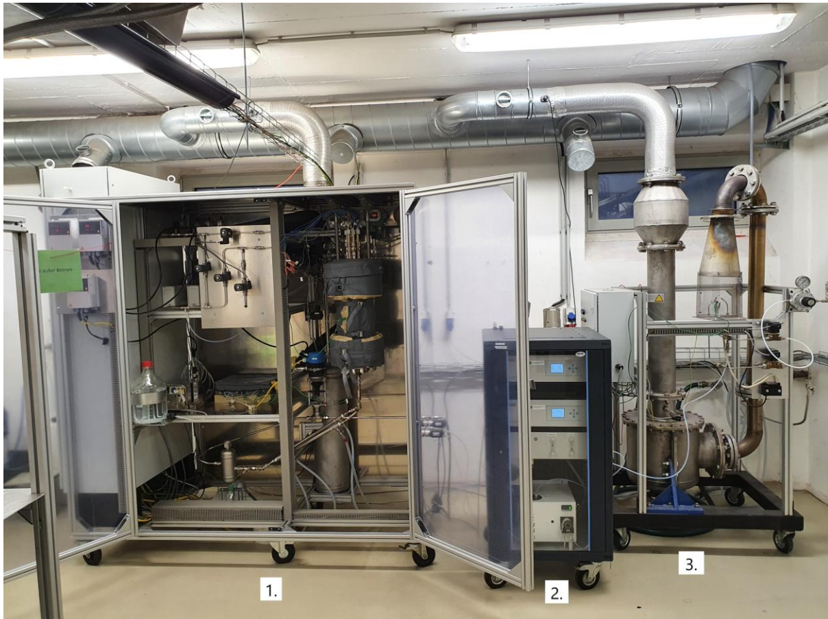
Abbildung 33: 1. Anlage, 2. Gasanalysegerät, 3. Fackel und Quenche
