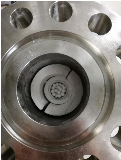
Abbildung 38: Der gefüllte Reaktor mit halbschalenförmiger Wärmedämmung (Ansicht: von unten)
