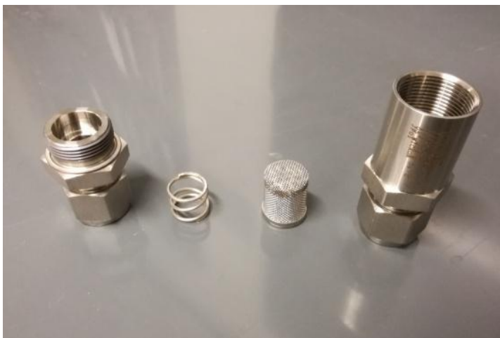
Abbildung 27: Aufbau eines 12 mm-Rohrleitungsfilters
