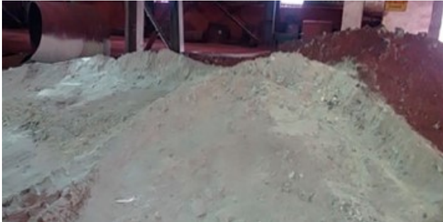
Abbildung 1: Erscheinungsbild von Pfannenschlacken nach Abkühlung (aus [28])
