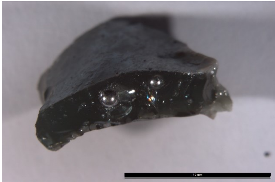
Abbildung 16: Korn aus Magnetprodukt S2 nach Brecher (eingeschlossene Stahlropfen)
