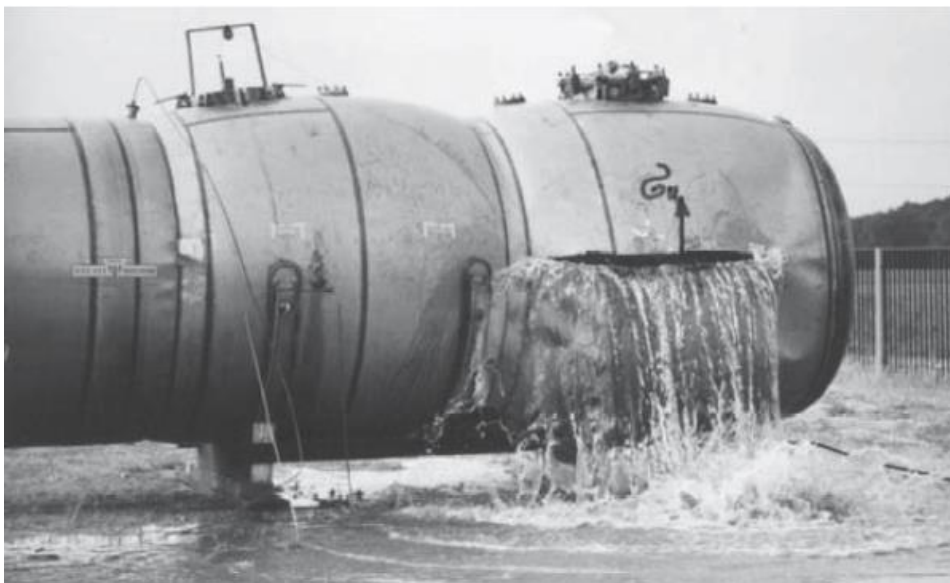
Abbildung 4: Längs aufgerissener Druckbehälter aufgrund der hohen Umfangsspannung [13]
