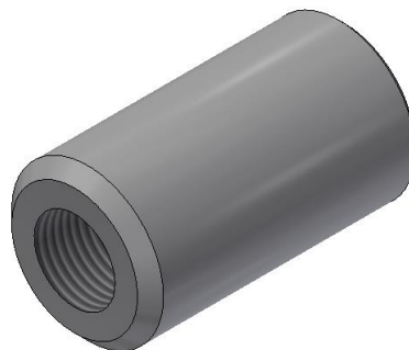
Abbildung 45: Einzuschweißende Muffe mit einem \frac{1}{2} " NPT Gewinde als Anschluss für diverse Komponenten
