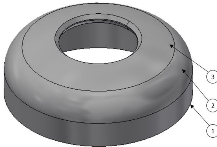
Abbildung 47: Klöpperboden mit Ausschnitt bestehend aus einem Bord (1), einer Krempe (2) und einer Kalotte (3)
