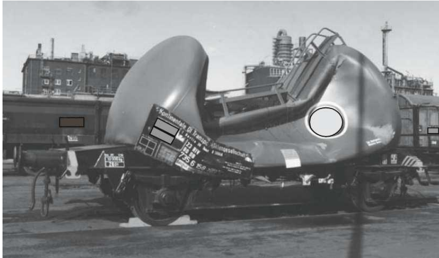
Abbildung 11: Durch äußeren Überdruck eingebeulter Kessel [22]
