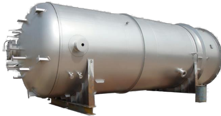
Abbildung 10: Druckbehälter zylindrischen Schuss und Stützring [26]
