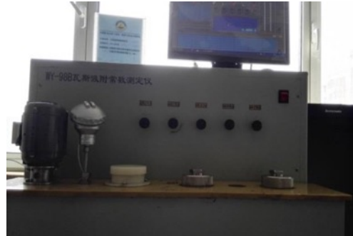
(d) Gas adsorption constant measuring instrument
