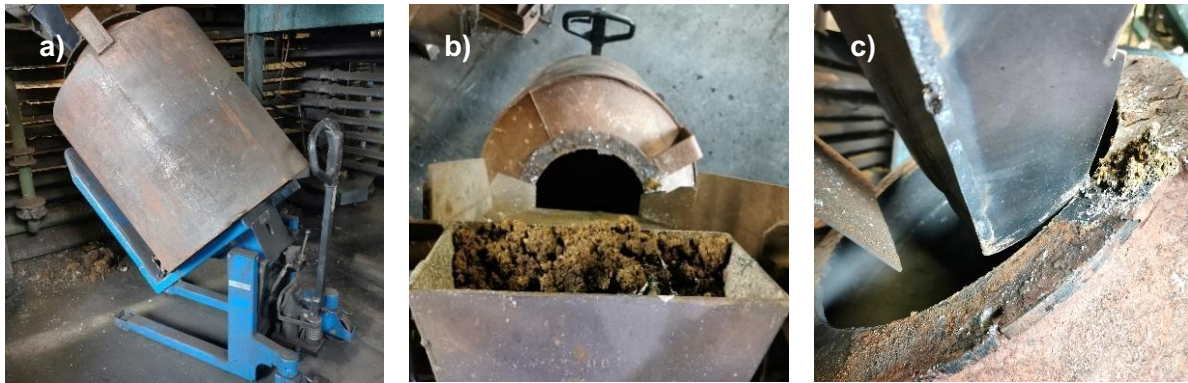
Abbildung 14: Positionierung der Trommel zur Befüllung mit Dross beim Kondensator
