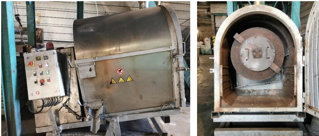
Abbildung 13: Drehtrommelofen von Pyrotek, installiert in der Batterierecyclingsanlage bei der BATREC Industrie AG
