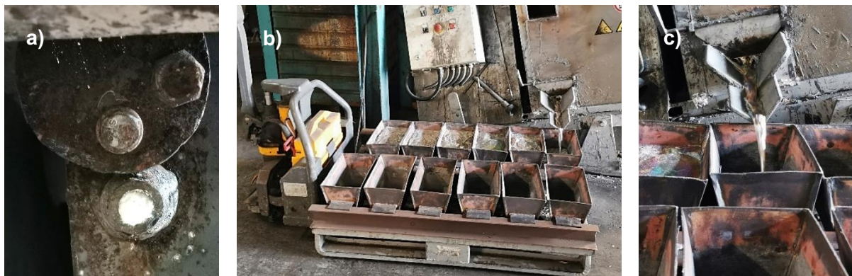
Abbildung 15: a) Abgussöffnung mit Mineralwolle abgedichtet, b) Abgussvorrichtung, c) Metallaustritt in Gussform
