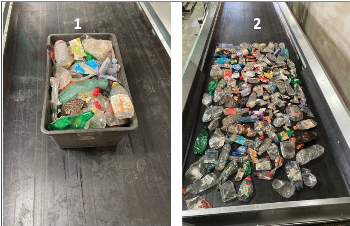
Abbildung 35 – Fotos vom Lichteinfluss-Versuch: 1) Wanne bekannten Volumens bis zum Rand mit PET-Flaschen gefüllt und 2) Materialaufgabe als Monoschicht.
