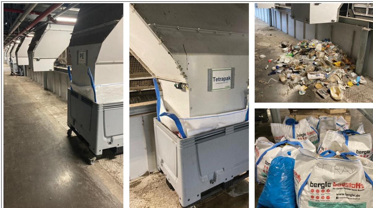
Abbildung 19 – Die Probenahme für die Fraktionen NE, PE, PET Flaschen, PET Tray, PP, PPK, GVK und Reste erfolgte über Probenahmetrichter zwischen Handsortierkabine und Ballenpresse.
