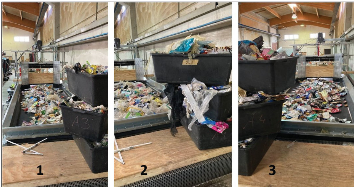
Abbildung 29 - – Um eine Materialverstopfung unter der 150 mm hohen „Höhenkontrolle“ durch nachschiebendes Material zu vermeiden, wurde zur Materialaufgabe ein Teil der Probe als Materialbett auf dem stehenden Band verteilt und ein Teil aus den Wannen auf das freiwerdende fahrende Band geleert. 1) Materialaufgabe der Folien-lastigen Mittelgut Grob-Fraktion, 2) Materialaufgabe Mittelgut Fein-Fraktion und 3) Materialaufgabe NE-Fraktion.
