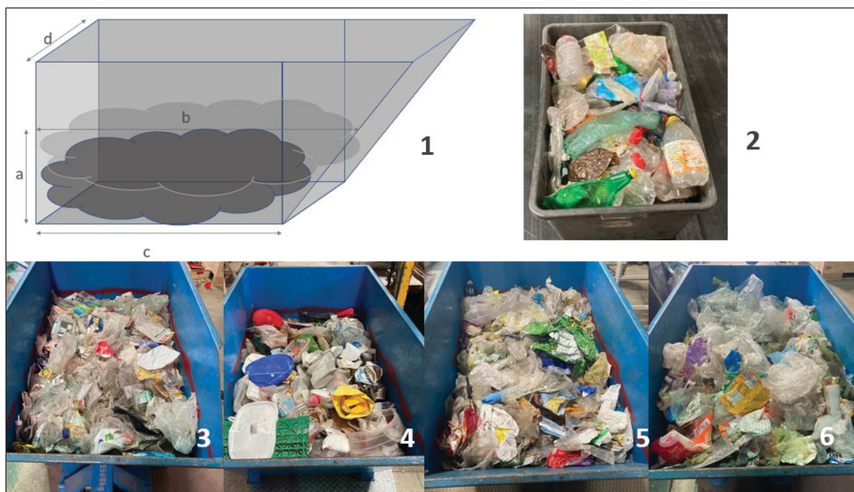
Abbildung 26 - 1) Mulde und 2) KS-Wanne zur Bestimmung des Probenvolumens sowie Beispielbilder vom Schüttvolumen der Fraktionen 3) PET Tray, 4) PP-, 5) Folien vor einem Einzelversuch & 6) Folien nach demselben Einzelversuch.
