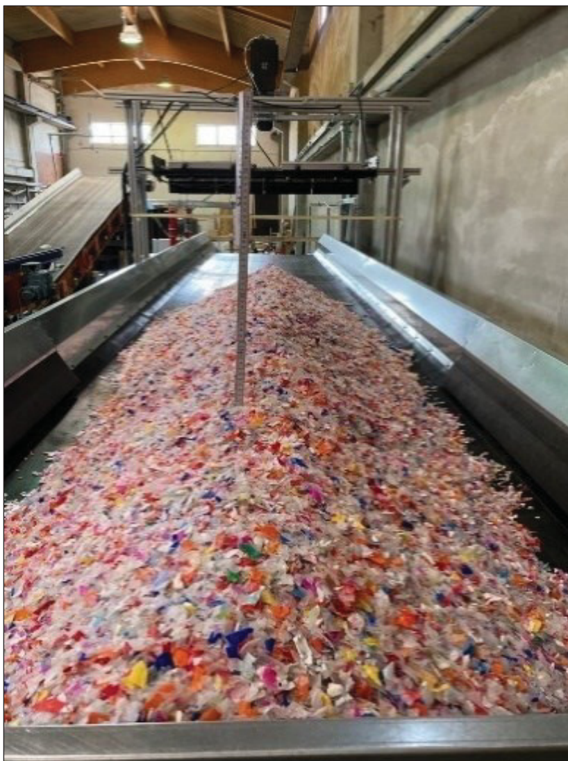
Abbildung 27 - Materialaufgabe Flakes-Referenzversuch (Schütthöhenversuch). Mittels Meterstab wurde das Erreichen der angepeilten Schütthöhe kontrolliert.
