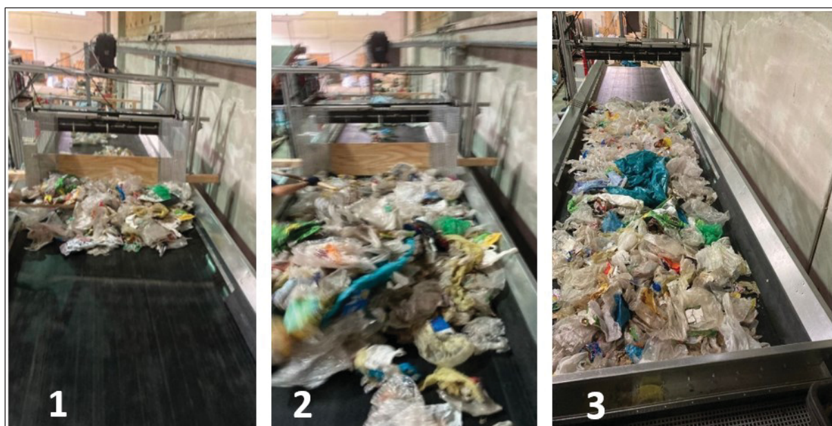
Abbildung 30 – Herausforderungen in der Materialaufgabe beim 150 mm Schütthöhenversuch. 1) Insbesondere Folien-lastiges Material türmte sich vor dem Abstreifer, 2) Versuche, das Material am laufenden Band aufzulockern, blieben erfolglos und 3) Der Abstreifer wurde abmontiert und die Folienfraktion als 150 mm hohes Schüttbett auf dem stehenden Band verteilt, wofür aufgrund der geringen Materialdichte mehrere Bandlängen notwendig waren.
