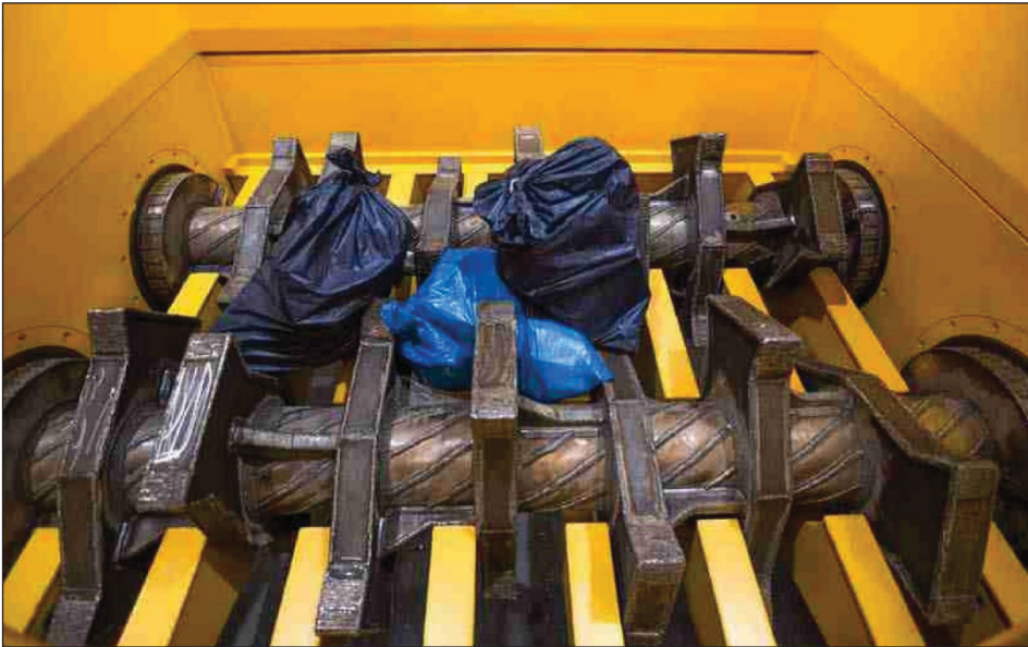
Abbildung 4 - Beispielbild eines Sackaufreißers (Vecoplan AG 2018).
