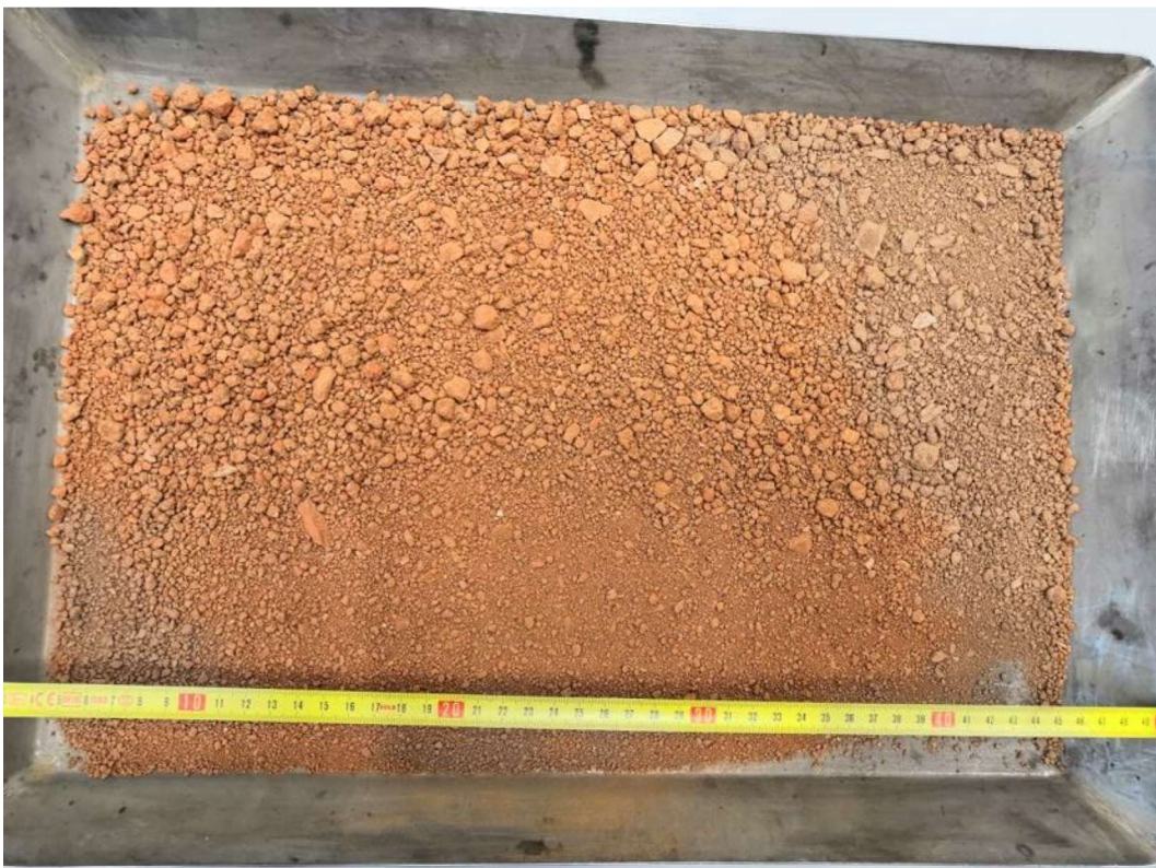
Abbildung 3-9: Probe nach Herausnahme aus dem Muffelofen bei 650 °C
