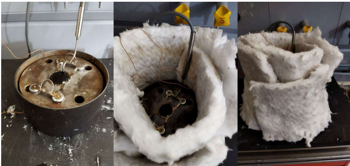
Abbildung 3-3: Versuchsaufbau zur Bestimmung der Wärmeleitfähigkeit. Zu sehen ist am ersten Bild die Probe im Metallring mit aufliegender Metallplatte, die anderen beiden Bilder zeigen die Isolierung des Mantels mit Dämmwolle. [19]
