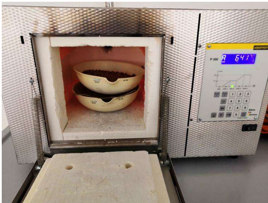
Abbildung 3-1: Bodenproben im Muffelofen zur Verbrennung der organischen Bestandteile
