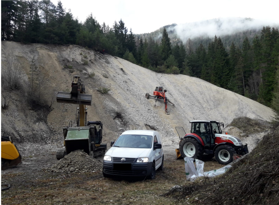
Abbildung 7: Beprobung der Halde Altstefania mit Schreitbagger und Seilwinde im April 2019.
