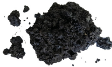
Abbildung 2: Sinterpartikel mit Bruchfragmenten [2]
