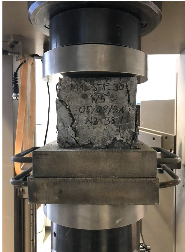
Abb.: 3-2: Probekörper im Versuchsaufbau nach der Druckprüfung
