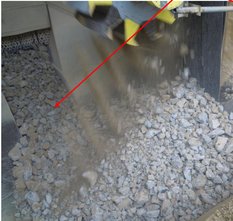
Gleichmäßige Brecherbelastung bzw. Verschleiß durch die Turbine
