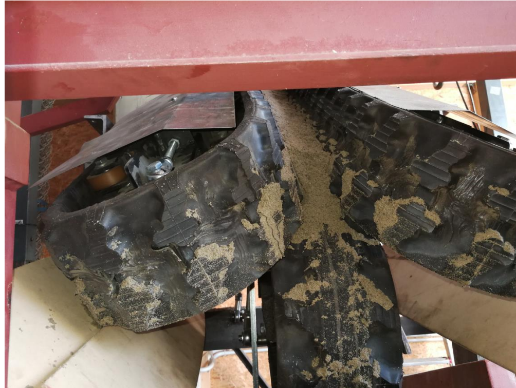
Gurtüberdeckung => Reduktion der Spaltverluste
