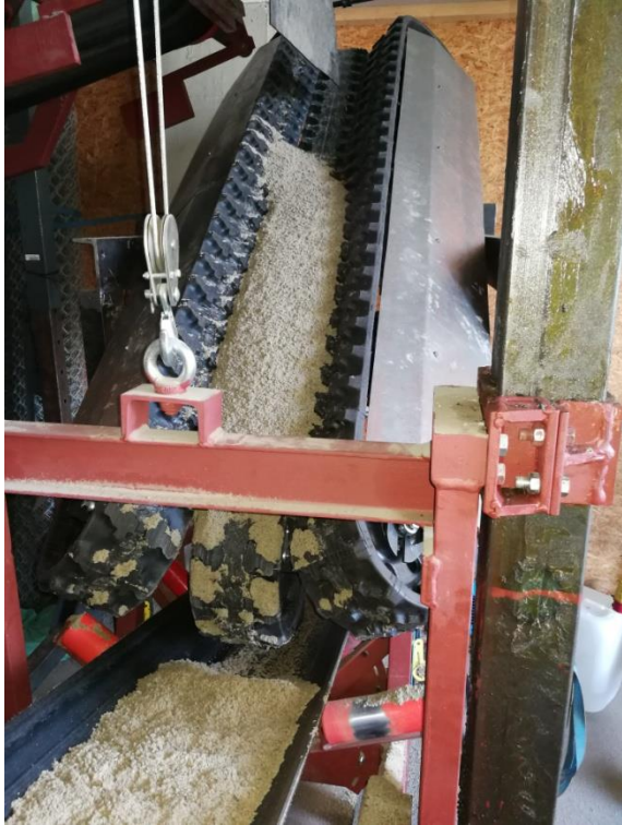
Erste Inbetriebnahme - Längskantenberührung
