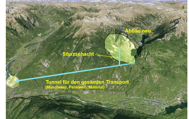
Variante 3: Schräger Tunnel und Sturzschaft
