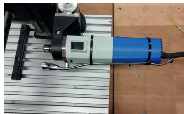
Bild 6. Fräsen an vertikalen Flächen
