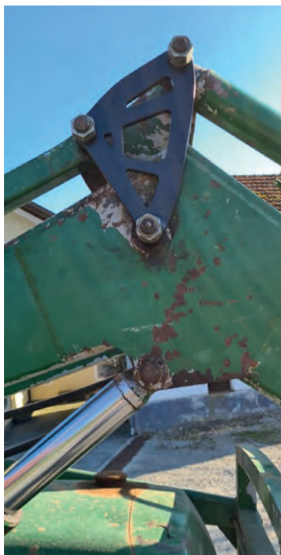
Bild 11: Eingebautes gegossenes Dreigelenk
