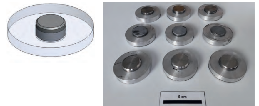
Bilder 13 und 14: Glaskörperdarstellung der Klebebauteilgeometrie (links) und gefertigte Klebeverbunde mit Mantel aus Aluminiumlegierung und Kernmaterial aus Eisenwerkstoff.
