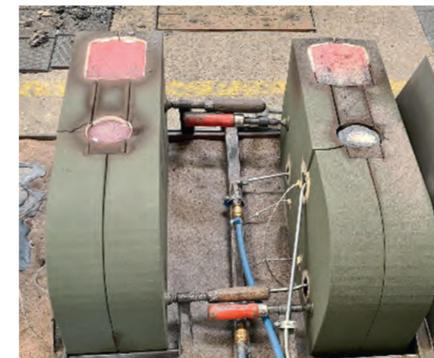
Bild 9: Abgossene 3D-gedruckte Formen
