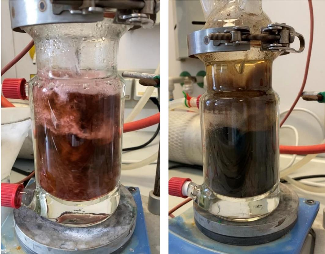
Abbildung 24: Veränderungen innerhalb der Lösung nach einigen Minuten  $\text{SO}_2$ -Durchspülung
