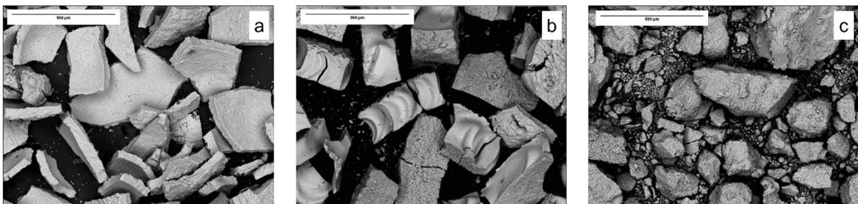
Abbildung 27: Änderung der Morphologie des Niederschlags mit zunehmender Versuchsdauer bei einer Durchgasung mit SO<sub>2</sub>/O<sub>2</sub> von 0,1/99,9 und einer Temperatur von 60 %. Die Versuchsdauern betragen 10 (a), 20 (b) und 60 (c) Minuten
