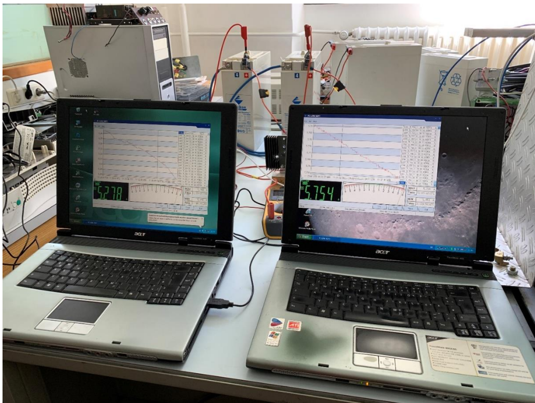
Abbildung 6-1: Versuchsaufbau zum Testen der Performance der Oerlikon 12CP50 Akkumulatoren
