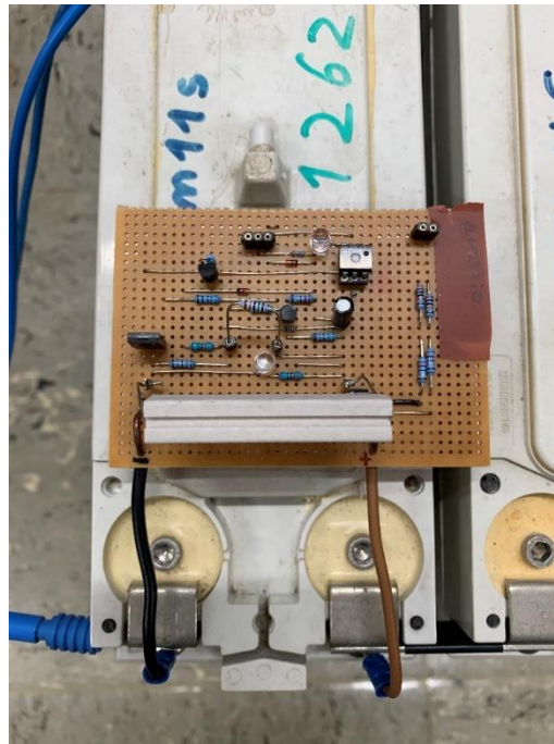
Abbildung 5-10: Verbindung einer Balancing-Platine mit einem Oerlikon Akkumulator
