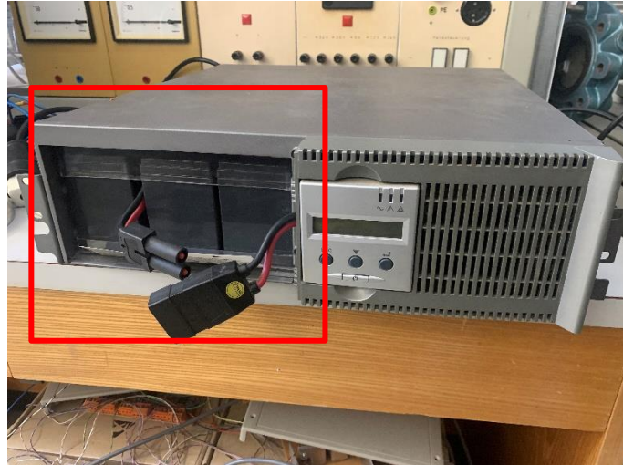
Abbildung 4-2: In der Markierung die integrierten Akkus mit einer Gesamtkapazität von 9 Ah
