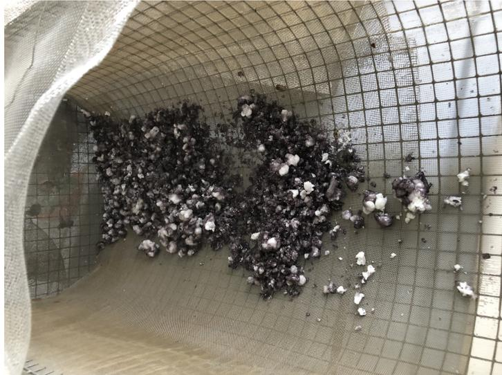
Abbildung 3.10.: Abgekühltes Produktgranulat im Auffangkorb der Nassgranulationsanlage
