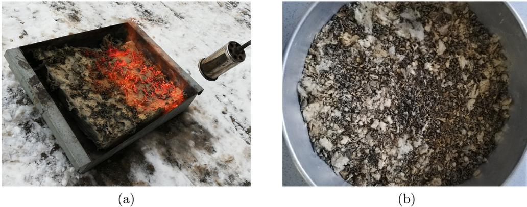
Abbildung 3.3.: ID b: (a) Glaswolle bei  $t = 0$  (b) Glaswolle nach Volumenreduktion mit Aufschweißbrenner nach  $t = 10$  min und Wechsel des Probenbehälters
