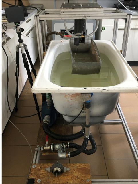
Abbildung A.5.: Versuchsaufbau der Nassgranulationsanlage mit Infrarotkamera
