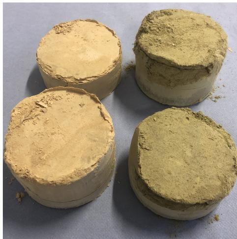
Abbildung 3.5.: Hergestellte Briketts aus Glaswolle (links) und Steinwolle (rechts) mittels Versuchsanlage der Firma ATM-Recyclingsystems
