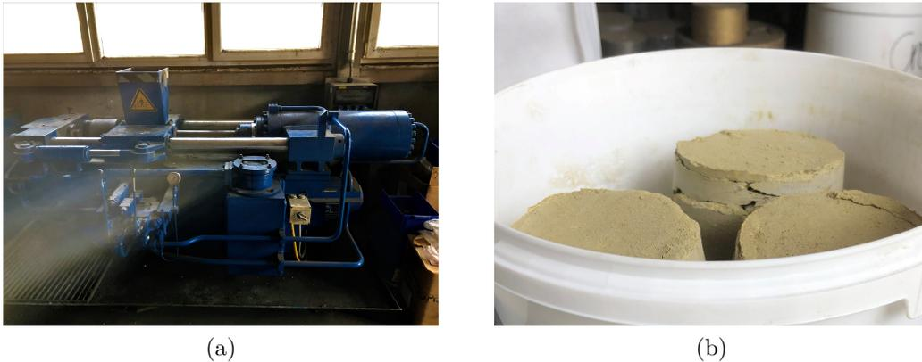
Abbildung A.1.: ID d: (a) Brikettierpress-Versuchsanlage der Firma ATM-Recyclingsystems (b) Hergestellte Briketts aus Steinwolle
