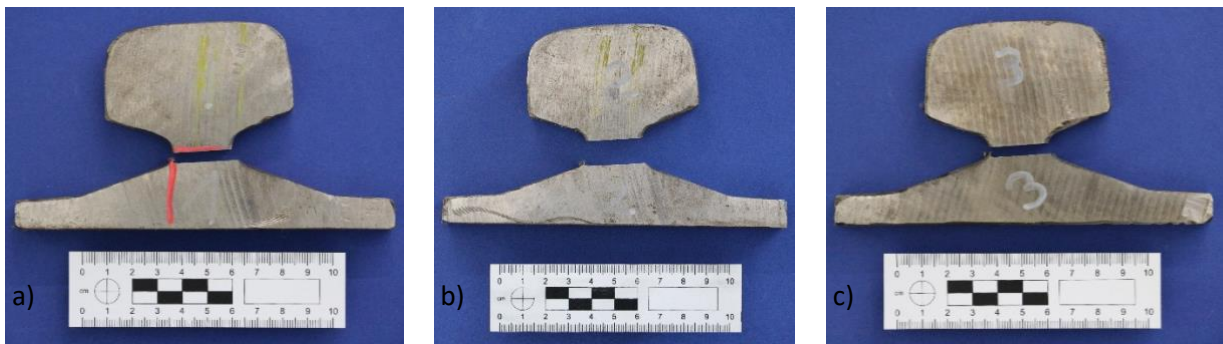
Abbildung 19: Probenkörper (jeweils Schienenkopf und Schienenfuß), welche für die Metallographie verwendet wurden.
