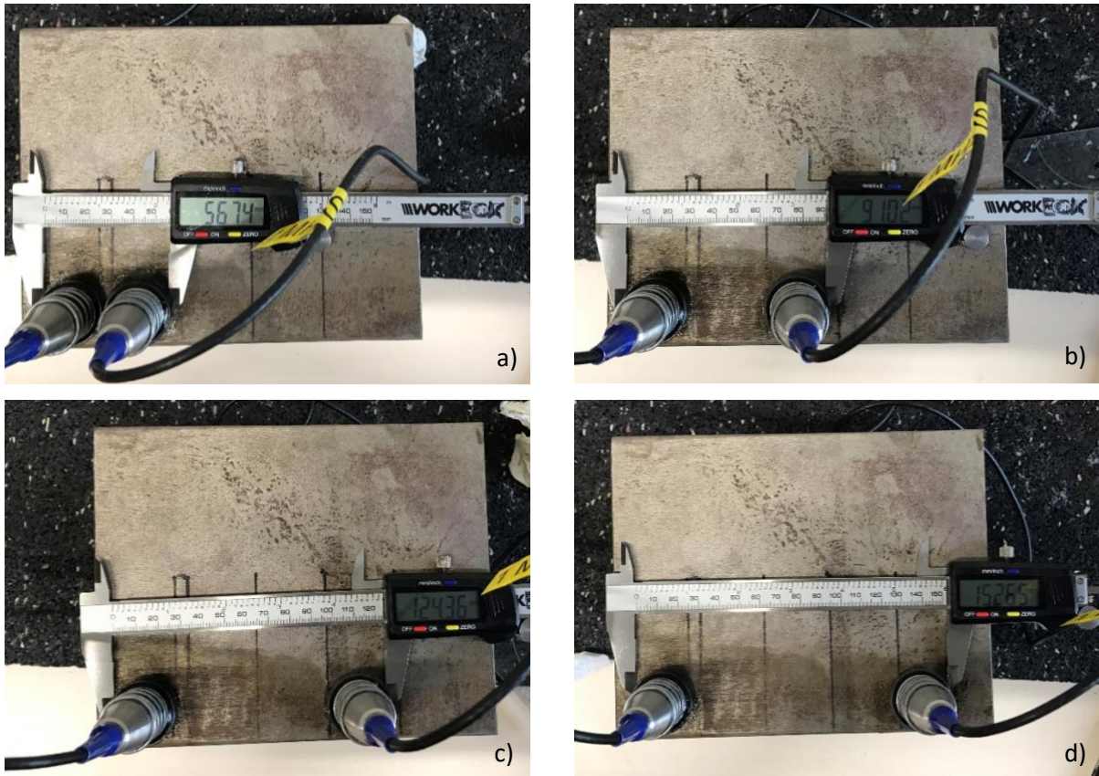
Abbildung 21: Messaufbau am Schienenfuß. Mit dem Messschieber wurden die äußeren Kämme der Comb-Wandler parallel zueinander ausgerichtet und die exakte Distanz gemessen.
