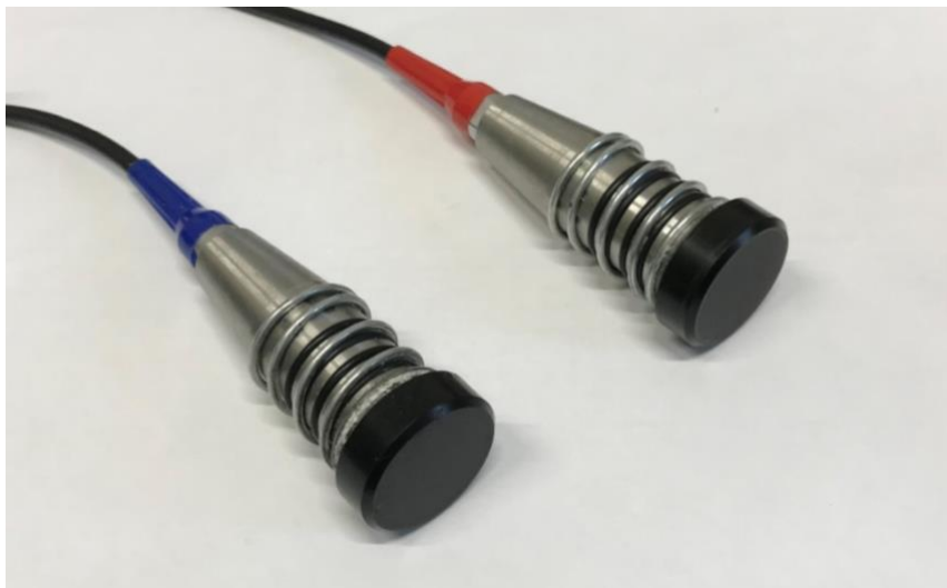
Abbildung 14: Die GAMPT 1 und 2 MHz Ultraschallsonden. Die blaue Markierung steht für eine 1 MHz Sonde. Die 2 MHz Sonde besitzt eine rote Markierung. Die Federn, welche die Sonden umgeben wurden für andere Experimente, welche nicht im Rahmen dieser Arbeit durchgeführt wurden, benötigt. Diese dienen somit keinem Zweck für diese Arbeit.
