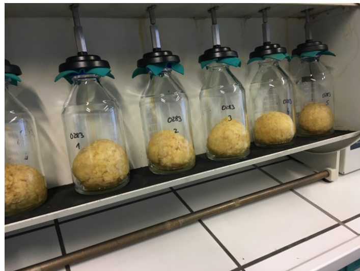
Abbildung 13: Elutionsversuche - Mineralwolleproben nach einigen Minuten im Schüttler (Aufnahme vom 19.5.2021).
