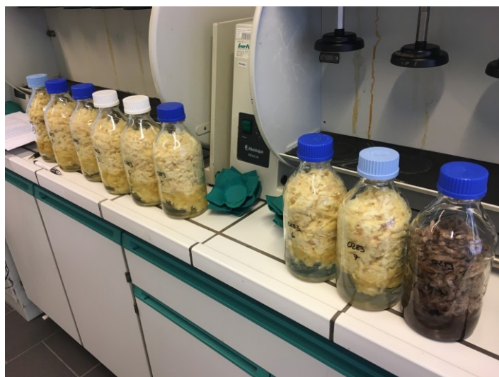
Abbildung 12: Mit den Proben und der Lösung befüllte Schüttelgläser vor dem Einspannen in den Schüttler (Aufnahme vom 19.5.2021).
