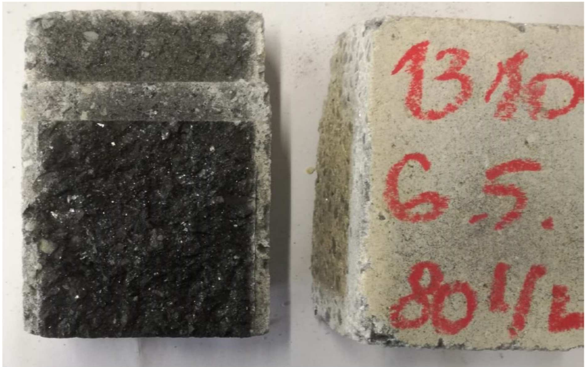
Abbildung 69: Probe nach KSP bei 1310°C und einer Spülrate von 80 l/h (Pechgebunden) [71]
