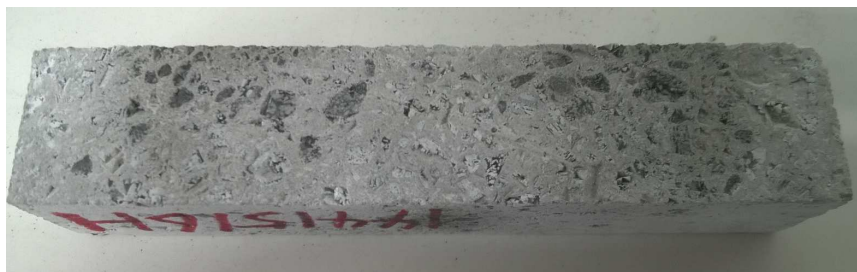
Abbildung 25: Probe nach E-Modulbestimmung
