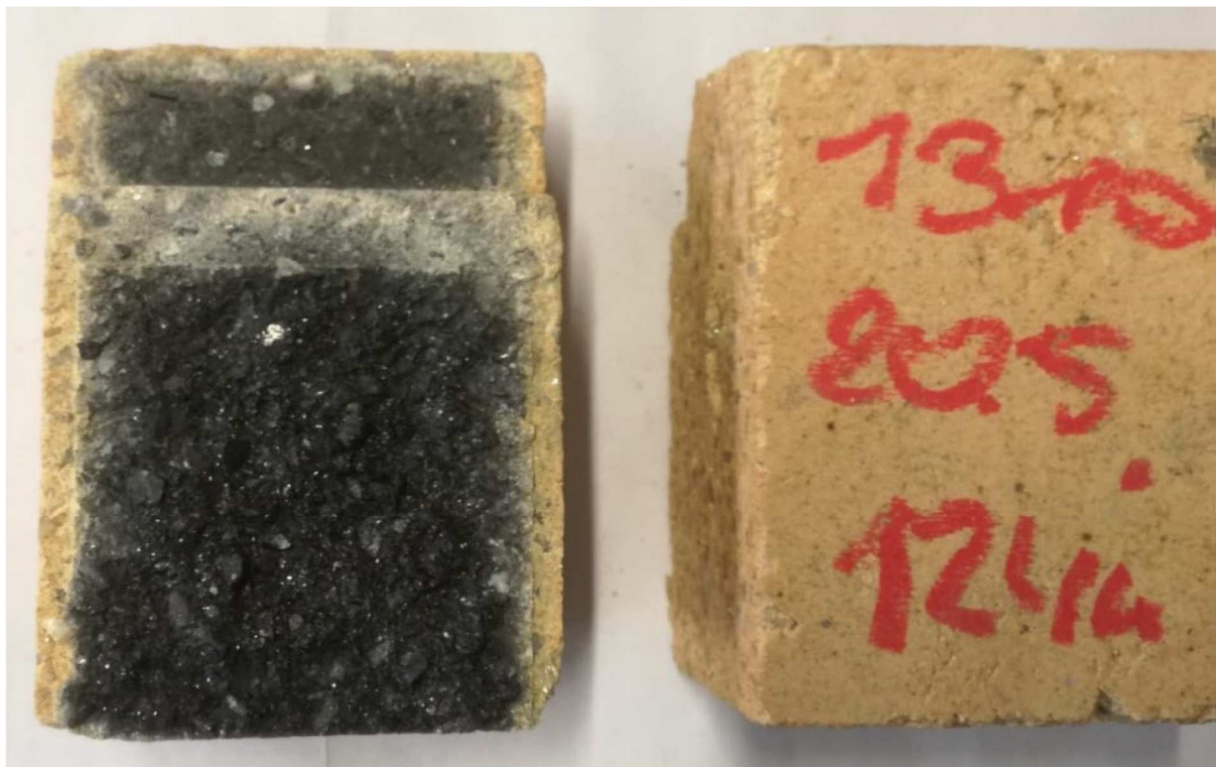
Abbildung 68: Probe nach KSP bei 1310°C und einer Spülrate von 12 l/h (Pechgebunden) [71]
