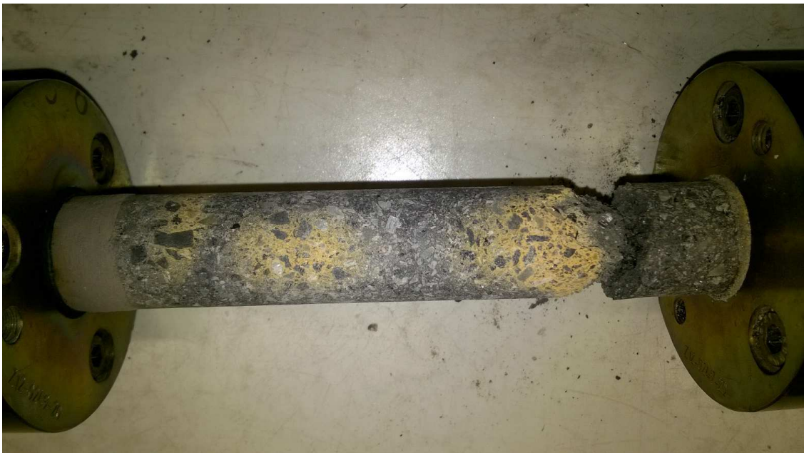
Abbildung 54: Zugkriechprobe nach einem Kriechversuch
