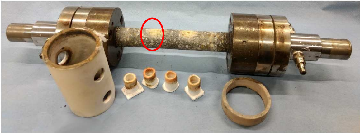
Abbildung 53: Zugkriechprobe nach einem Kriechversuch [71]
