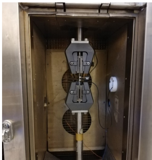
Abbildung 26: Prüfaufbau Kriechversuch in der Temperierkammer für die Instron 4505
