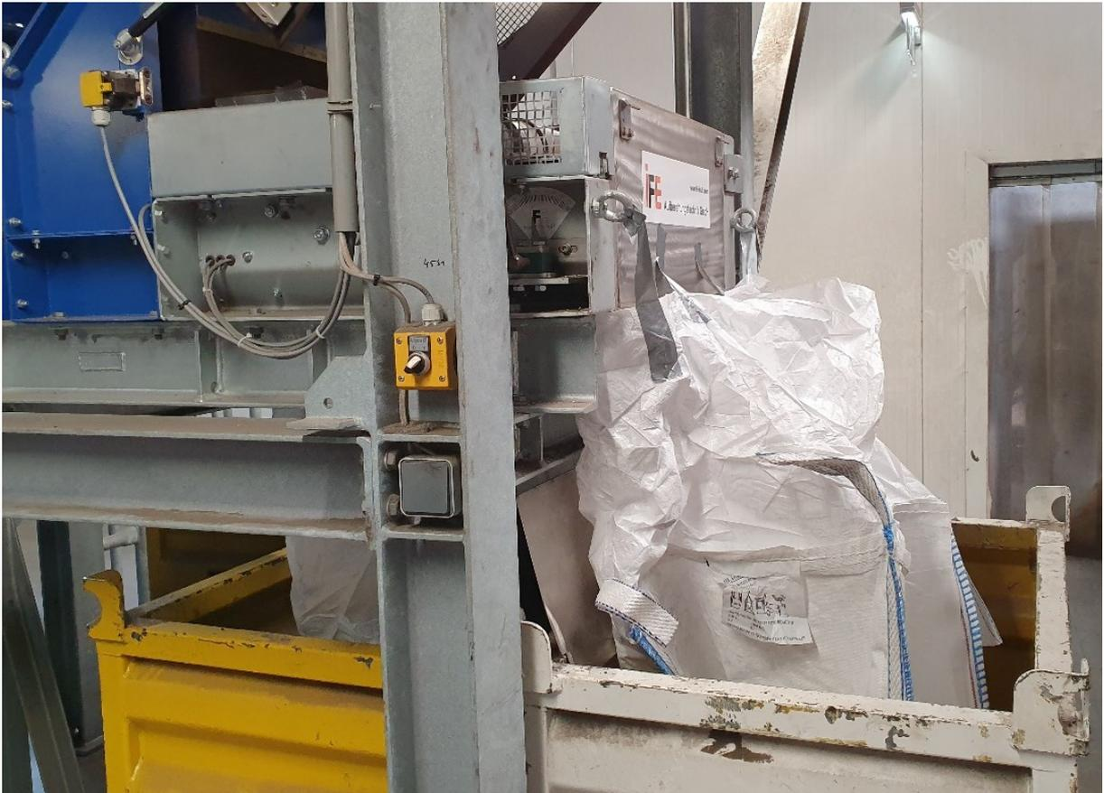
Abbildung 6.2 Probenahmestelle – Beprobung der Produkte am Magnetbandwalzenscheider
