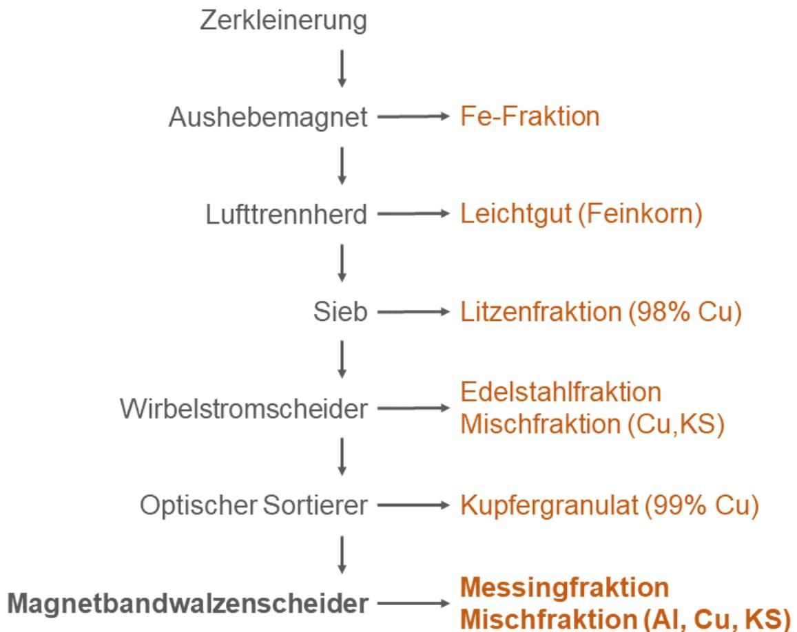
Abbildung 6.1 Schematischer Verfahrensstammbaum einer modernen Kabelschrott-Aufbereitungsanlage
