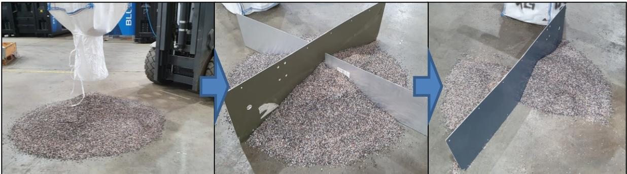
**Abbildung 7.2 Probenteilung mittels Schüttkegel**
