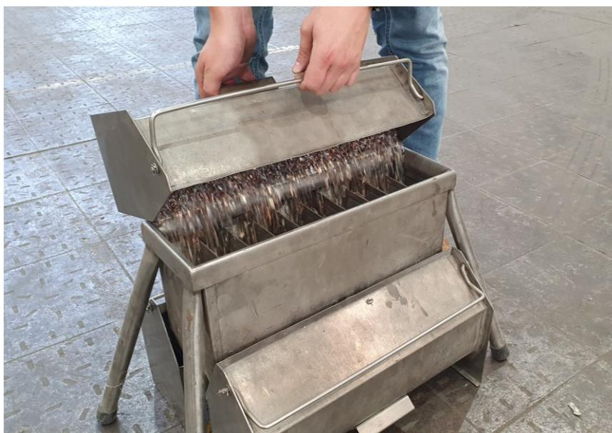
**Abbildung 7.3 Probenteilung mittels Riffelteiler**
