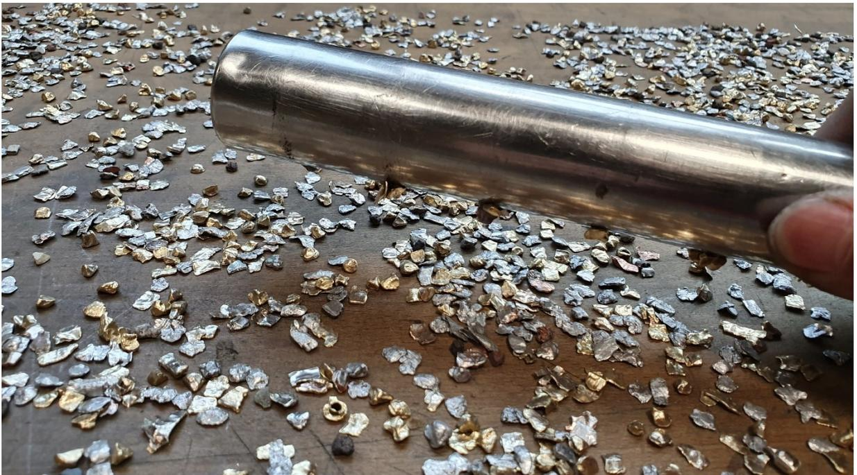
Abbildung 6.6 Einteilung in Flusssichteklassen mittels Aushebemagnet
