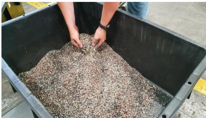
**Abbildung 7.4 Homogenisieren der Versuchsproben**
