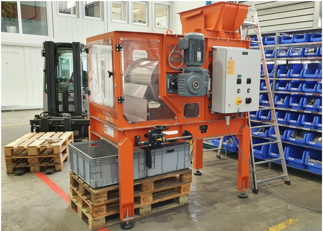
**Abbildung 7.5 Trommelmagnetscheider vom Typ KHP 500x650 Z/11 (IFE Aufbereitungstechnik)**
