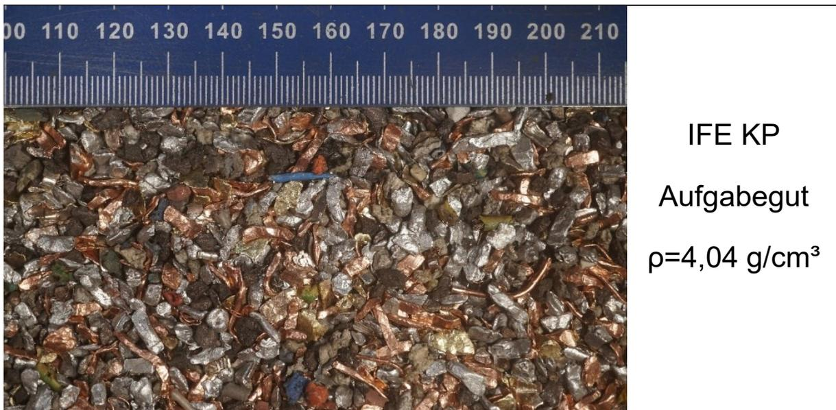
Abbildung 6.3 Aufgabegut Magnetbandwalzenscheider – Probe IFE KP
