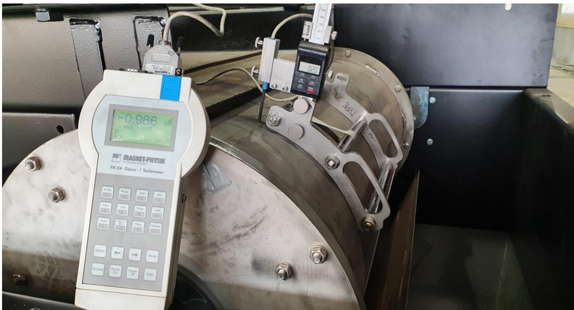
**Abbildung 5.2 Messaufbau – Abnahme der Flussdichte radial zur Trommeloberfläche**
