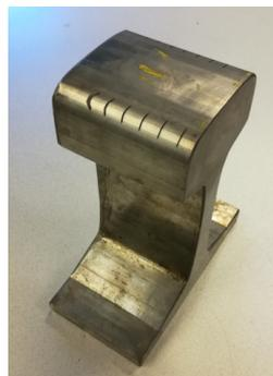
Abb. 5.2: Bild des Referenzkörpers aus Manganhartstahl (RP05)
