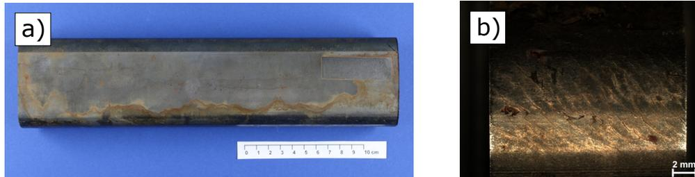
Abb. 5.4: a) Bild der Schienenprobe RP02, b) Vergrößerung der Fahrkante mit Head Checks
