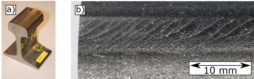
Abb. 5.12: a) Bild des Schienenkörpers RP04, b) Vergrößerung der Fahrkante mit Head Checks
