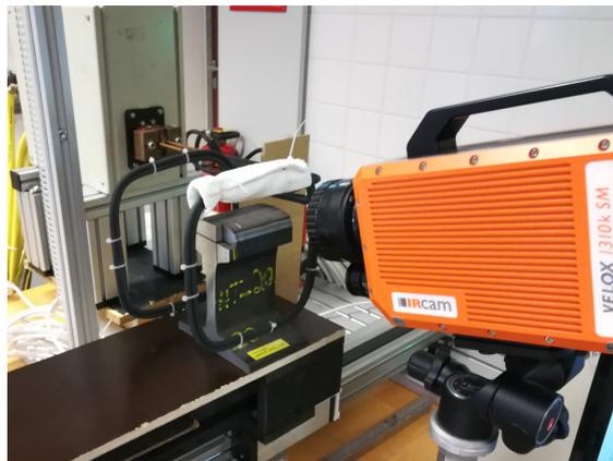
Abb. 6.13: Versuchsaufbau zum Erstellen von Panoramabildern
