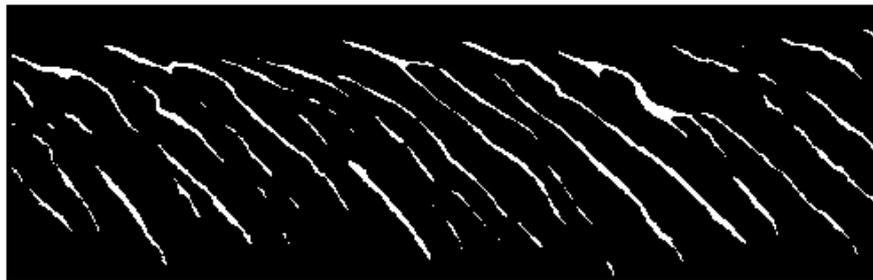
Abb. 4.17: Kanten der Head Checks im binarisierten Bild nach einer morphologischen Erosion.
