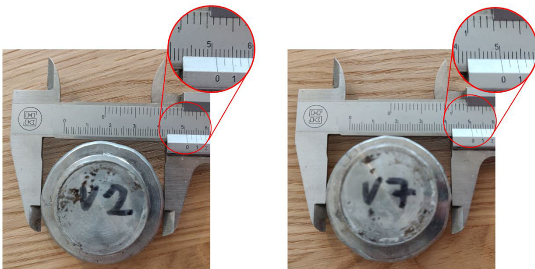
Abbildung 4.12.: Vergleich zweier Proben (links: 450°C / rechts: 250°C)
