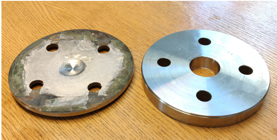
Abbildung 4.13.: Gebrochenes Untergesenk nach der Kaltumformung
