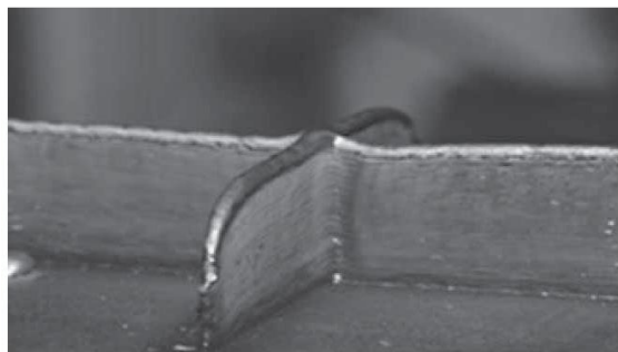
Abbildung 2.7.: Kreuzstruktur mittels WAAM-Verfahren hergestellt[5]
