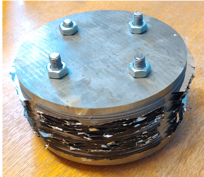
Abbildung 4.6.: Vollständig verspannte Blechpakete
