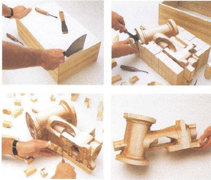
Abbildung 2.12.: Nachbearbeitung des fertiggestellten LOM-Quaders[10]
