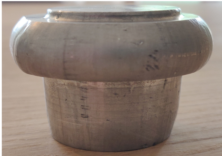
Abbildung 4.10.: Schmiedeteil (Warmumformung bei 450^{\circ}\text{C} )
