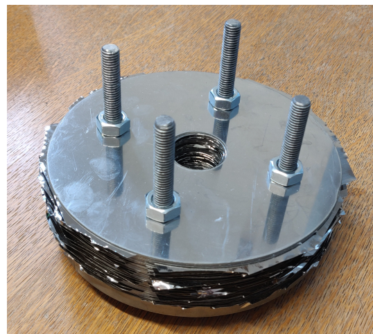
Abbildung 4.5.: Zugeschnittene Hartlotfolie & Gestapelte Blechschichten
