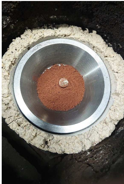
Abbildung 3-6: Feuerfestring (grau) und Stahltiegel mit 25 g Erz im Reaktor [51]
