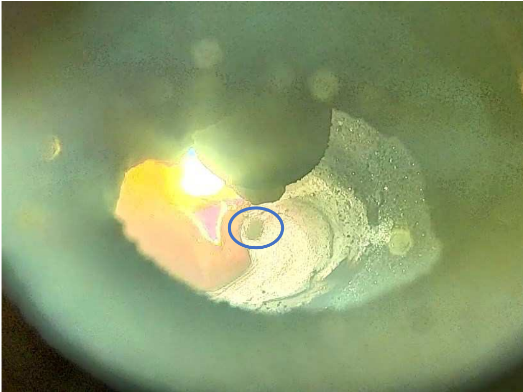
Abbildung 3-9: Kamerabild während Chargierung, Erz ist markiert
