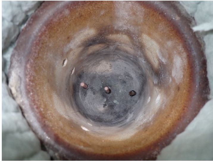
Abbildung 8: Feuerfester Tiegel (Draufsicht) in leerem Zustand
