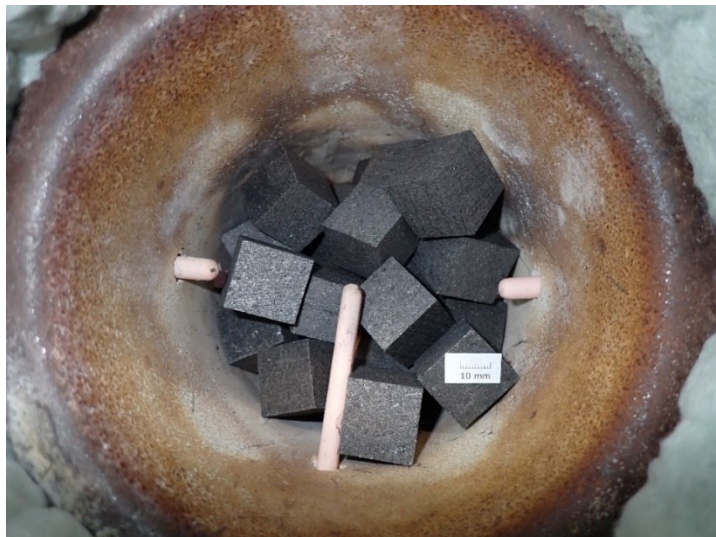
Abbildung 9: Feuerfester Tiegel (Draufsicht) inklusive Graphitschüttung
