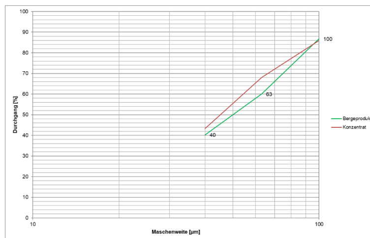
Abbildung 22: Graphische Darstellung der Korngrößenverteilung von Konzentrat und Bergeprodukt im einfach-logarithmischen Netz
