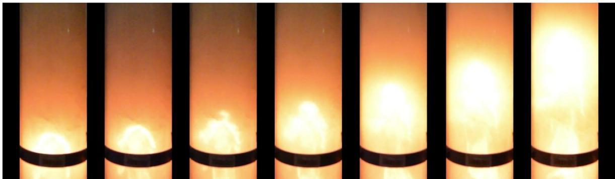
Abbildung 79: Bildserie der Flammenausbreitung in einem Lycopodium/Luft-Gemisch in einer kleinen Rohrapparatur (140 mm Querschnitt)
