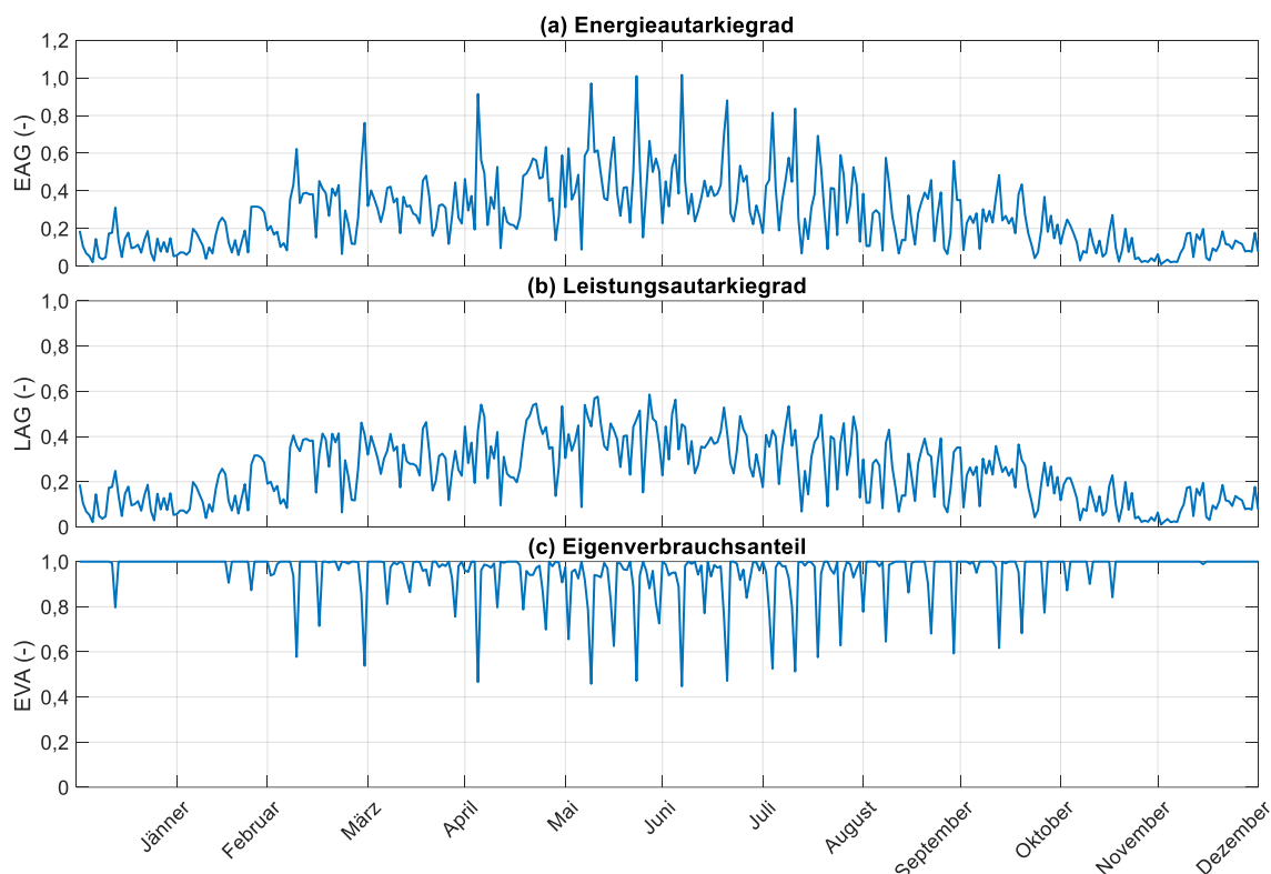
Abbildung 5-61: (a) Energieautarkiegrad (b) Leistungsautarkiegrad und (c) Eigenverbrauchsanteil für eine Durchdringung von 60% PV und 100% EV (NVB) bei 3,7 kW Ladeleistung und Ladestrategie 1 für das Gesamtsystem (Tageswerte)
