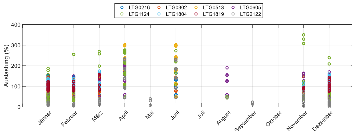
Abbildung 5-36: Zeitliches Auftreten (Monat) der maximalen Auslastung der acht am meisten belasteten 5-kV Leitungen je Szenario für Ladestrategie 1
